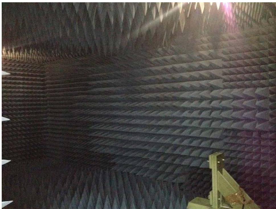
Figura 5.1: Vista da câmara anecoica na direção para onde os oradores falavam.
