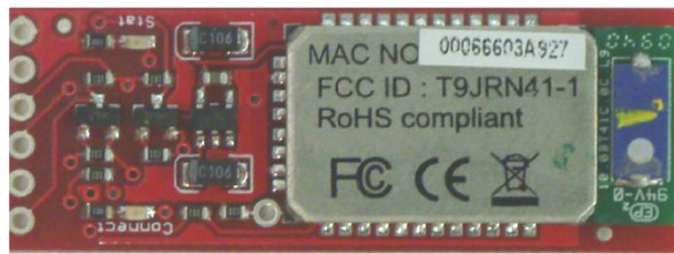
Figura 4.15 Módulo de comunicação sem fios Sparkfun™ Ref.: WRL-00582
