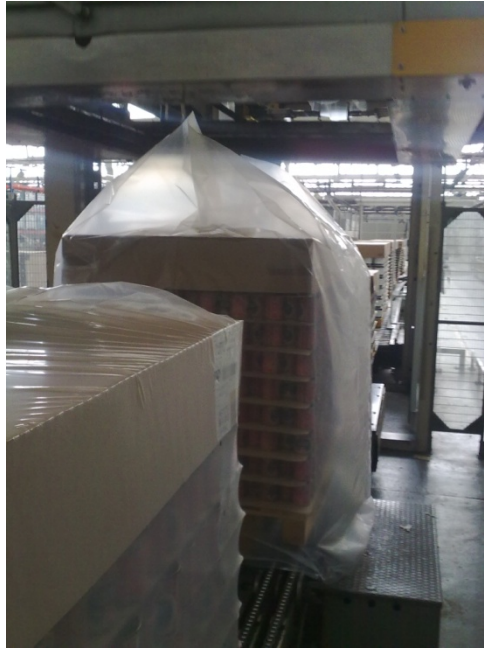
Figura 12 – Operação de finalização do embalamento. Colocação da manga retráctil.
