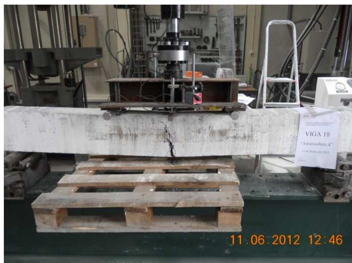
Fig. 63 – Forma de rotura da viga 18
