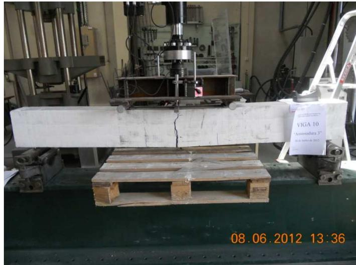
Fig.48 – Forma de rotura da viga 10
