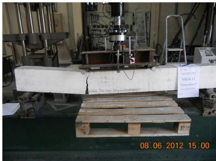
Fig. 49 – Forma de rotura da viga 11
