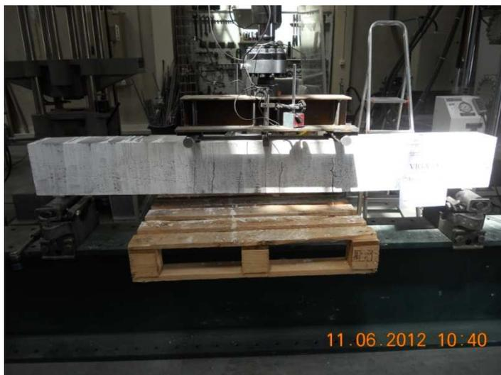
Fig. 58 – Forma de rotura da viga 15
