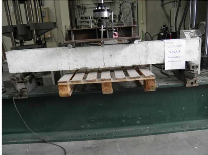
Fig. 41 – Forma de rotura da viga 3
