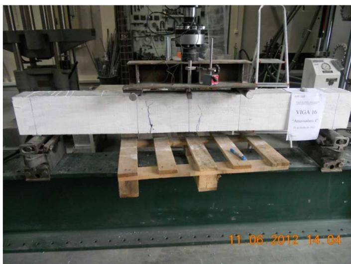
Fig. 61 – Forma de rotura da viga 16
