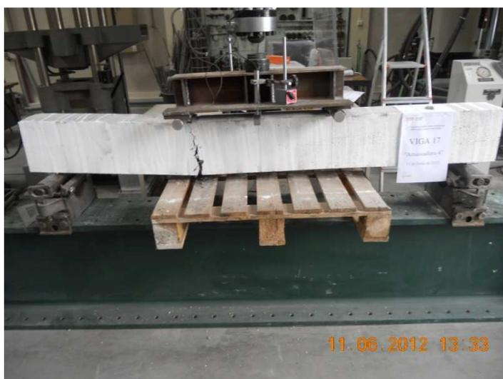
Fig. 62 – Forma de rotura da viga 17
