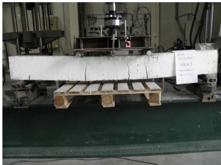
Fig.40 – Forma de rotura da viga 2
