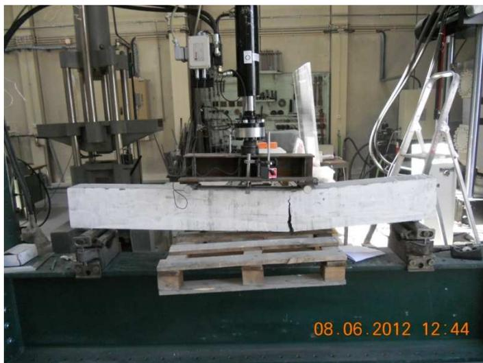
Fig. 50 – Forma de rotura da viga 12
