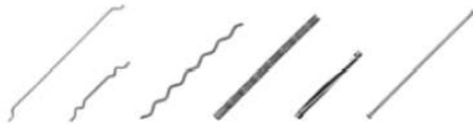
Fig. 1 – Formas de fibras encontradas frequentemente no mercado
