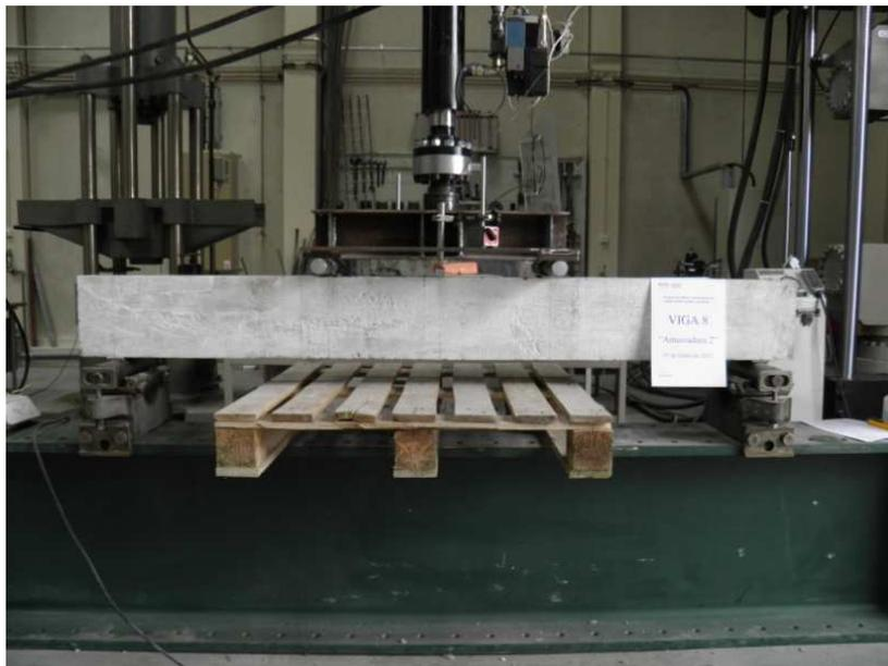
Fig. 36 - Exemplo de viga pronta a ensaiar
