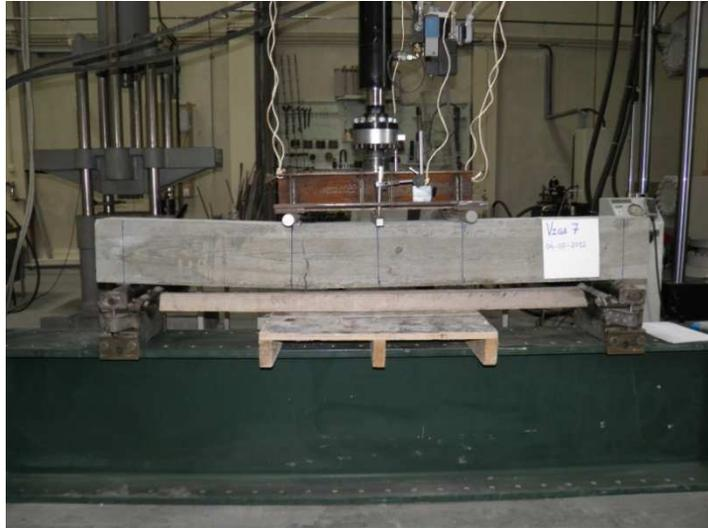
Fig. 52 – Forma de rotura da viga 7
