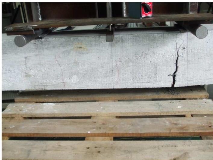
Fig. 54 – Forma de rotura da viga 9
