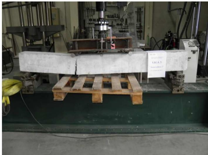
Fig. 44 – Forma de rotura da viga 5
