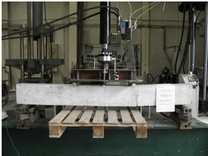
Fig. 53 – Forma de rotura da viga 8
