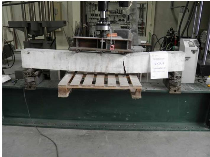
Fig. 43 – Forma de rotura da viga 4
