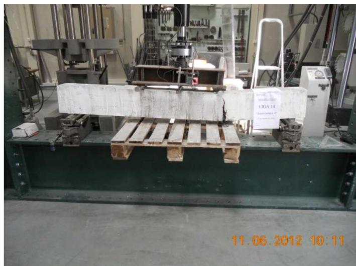
Fig. 57 – Forma de rotura da viga 14
