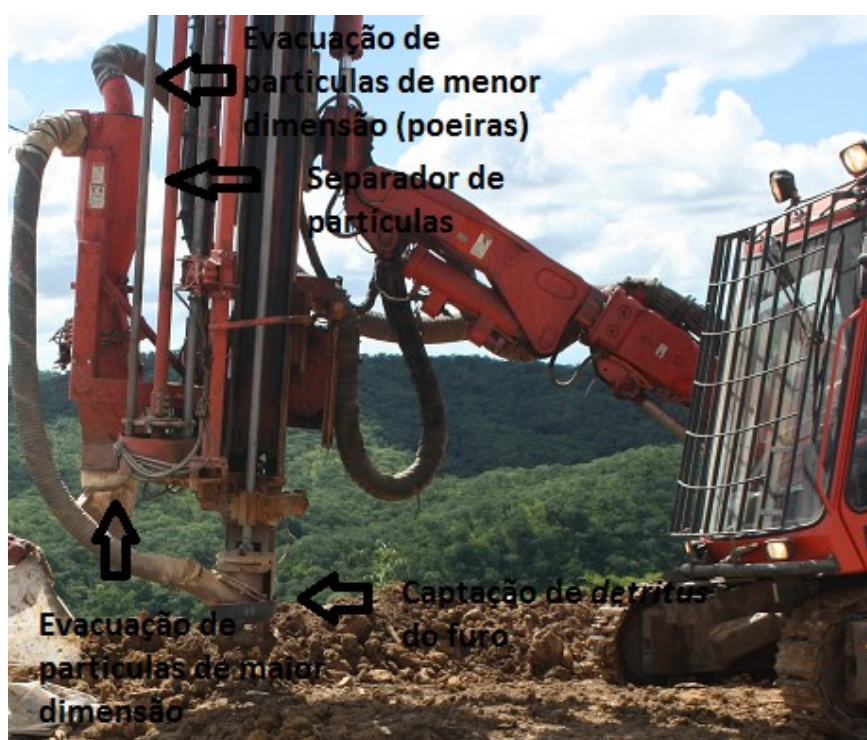
Fig. 10 - Modo de Limpeza do furo de um equipamento de perfuração a céu aberto – (DP800i – sandvik)
