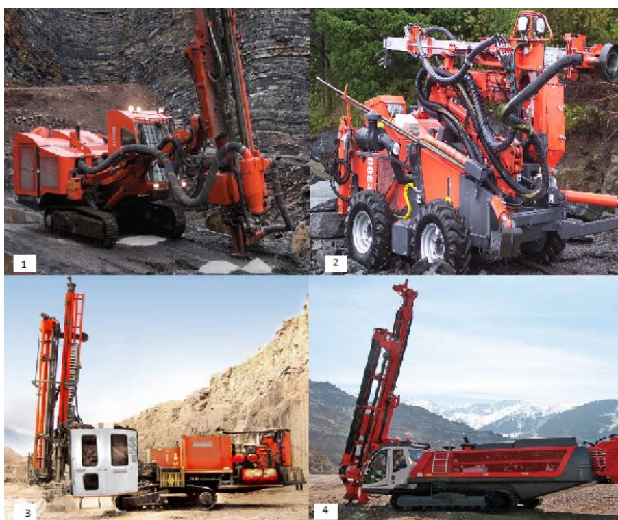
Fig. 12 - 1) DP800i martelo à cabeça (76 – 127mm) 2) DC302R martelo à cabeça (28 – 64mm) 3) –DR560 martelo de fundo (115 -216mm) 4) – DI600 martelo de fundo (89 – 190mm) – Equipamentos Sandvik
