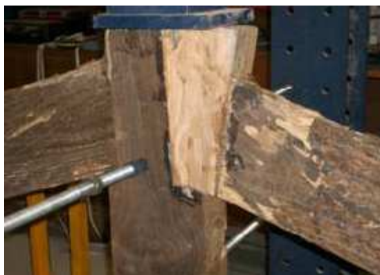
Figura 56 – Ligação pendural – pernas reforçada com colagem de nova madeira (Rodrigues, R., 2004)
