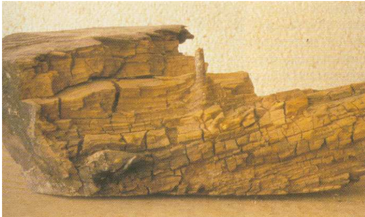
Figuras 83 – À esquerda, exemplo de podridão parda. À direita, exemplo de podridão branca ou fibrosa. [Arriaga, 2002]
