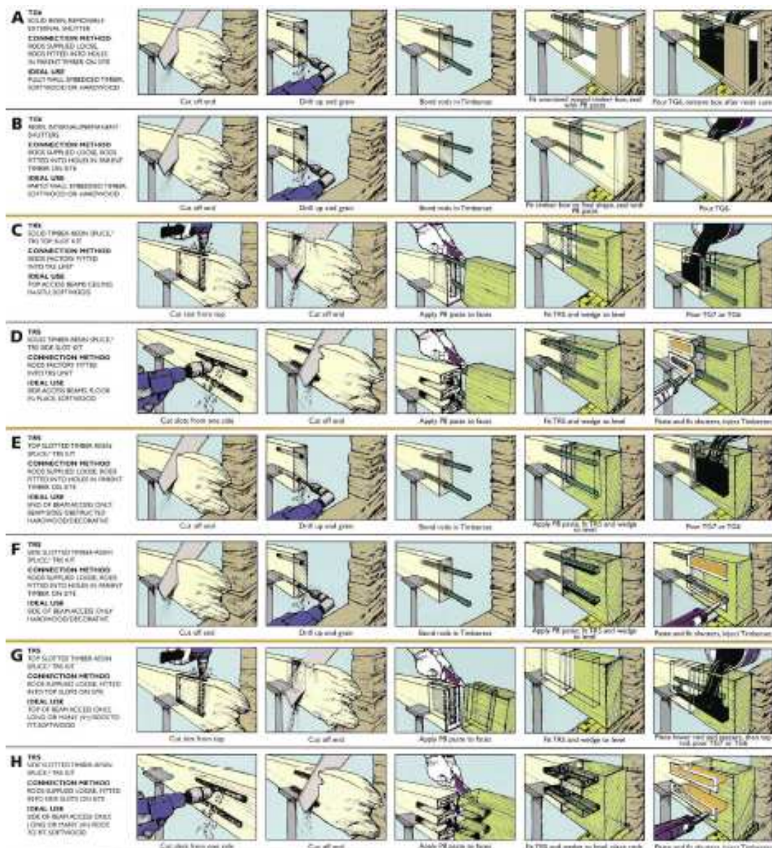
Figura 130 – Esquema de diversas técnicas de substituição de entrega danificada por próteses de resina de epóxico (ROTAFIX, 2007)
