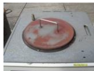
Figura 13 – Tampa da entrada de resíduos e a ligação para saída do ar interior
