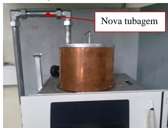
Figura 21 – Novo circuito de ar exterior
