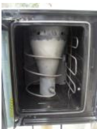
Figura 14 – Interior do forno com o cone de descontaminação
