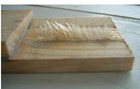
Figura 3. 28 – Fibras levantadas nos provetes da série 4.
