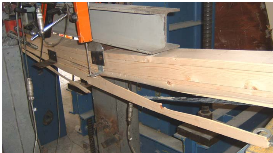
Figura 4. 56 – Rotura da viga V08.
