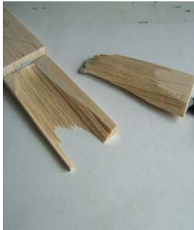
Figura 3. 34 - Provede da série 6. Rotura por corte em bloco da madeira.
