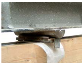
Figura 4. 18 – Elementos adicionados para permitir o escorregamento do laminado. Apoio que permite o escorregamento e apoio que não permite o escorregamento.
