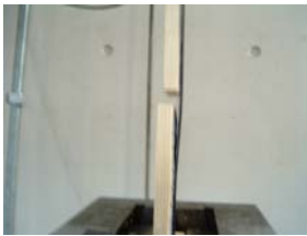
Figura 3.7 – Excentricidades observadas no provete antes do ensaio.
