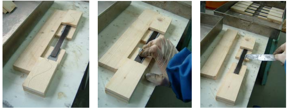
Figura 3. 14 – Colagem do laminado: aplicação de pressão e remoção da resina em excesso.
