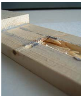
Figura 3. 37 - Provette da série 7. Rotura da madeira, originada pela presença de nós.
