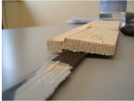
Figura 3. 35 – Provede da série 6. Rotura por corte em bloco da madeira, originada pela presença de nós e pela zona da medula.
