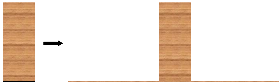
Figura 4. 40 – Transformação da secção em secção homogeneizada
