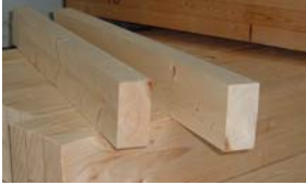
Figura 3.1 – Lamelas usadas para a execução dos provetes pequenos.
