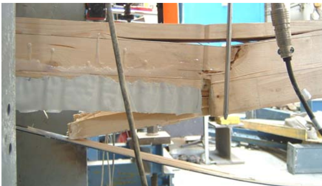
Figura 4. 60 – Rotura da viga V10.
