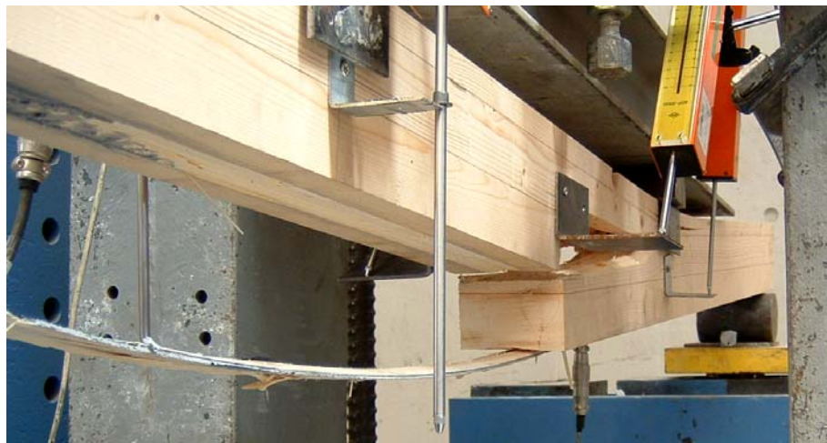
Figura 4. 64 – Rotura da viga V16.
