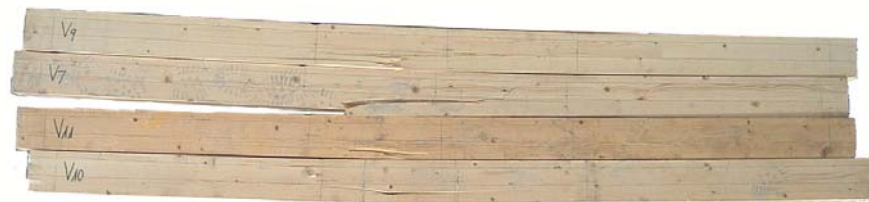
Figura 4. 19 – Vigas após cedência (série referência).
