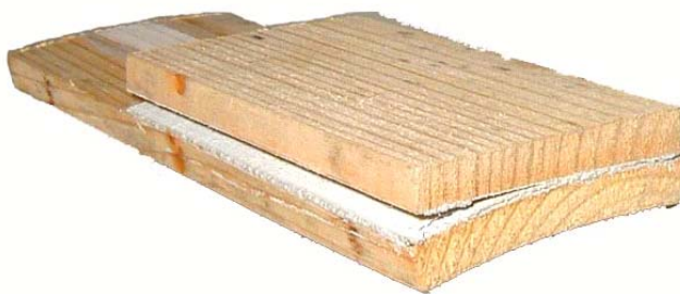
Figura 2. 22 – Peças de madeira descoladas devido a variações dimensionais.
