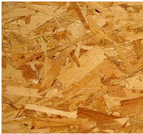
Figura 2. 8 - Aglomerado de partículas de madeira longas e orientadas OSB [13]
