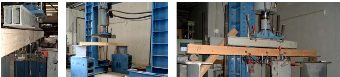
Figura 4.5 – Equipamento utilizado nos ensaios de determinação do ME à flexão.
