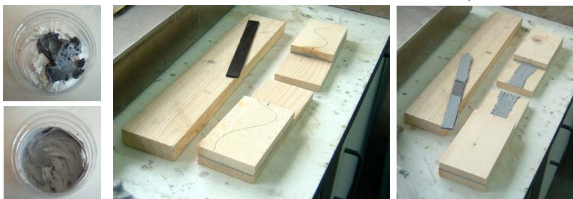
Figura 3.13 – Elaboração e aplicação da resina.
