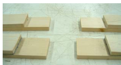
Figura 3.12 – Peças de madeira coladas pela marcação.
