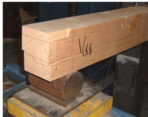
Figura 4. 61 – Rotura da viga V11.
