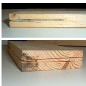
Figura 3. 5 – Corte irregular na execução do primeiro provete.
