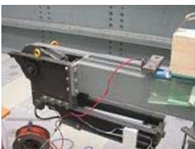
Figura 2. 33 – Detalhe do aparelho durante o processo de pré-esforço de uma viga de madeira [25].
