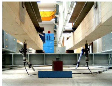
Figura 4. 16 – Disposição dos dispositivos LVDT.
