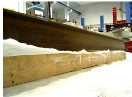
Figura 4. 21 – Colagem da viga, sujeita à aplicação de carga para eliminação da deformação.
