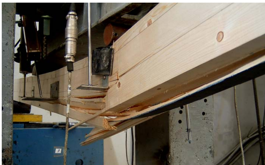
Figura 4. 52 – Rotura da viga V05. Pormenor da separação por corte do laminado.
