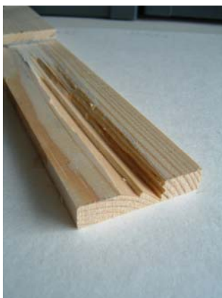
Figura 3. 36 - Provede da série 7 e da série 6. Rotura dos anéis da madeira na direção tangencial e transversal.
