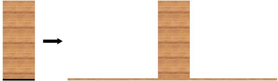
Figura 4. 33 – Transformação da secção em secção homogeneizada
