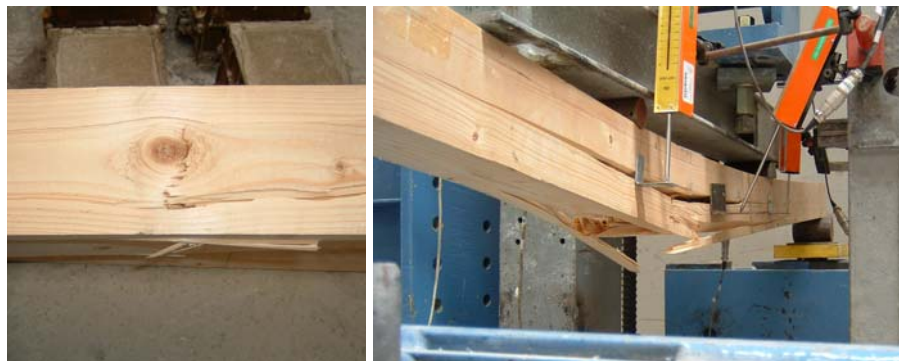
Figura 4. 48 – Rotura da viga V11.
