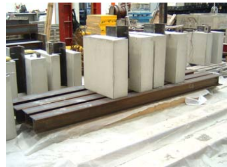
Figura 4. 21 – Colagem da viga, sujeita à aplicação de carga para eliminação da deformação.
