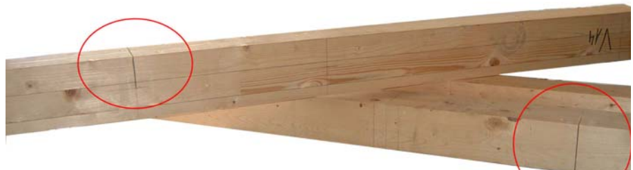
Figura 4. 25 - Corte da face inferior até ao eixo neutro, a meio vão.
