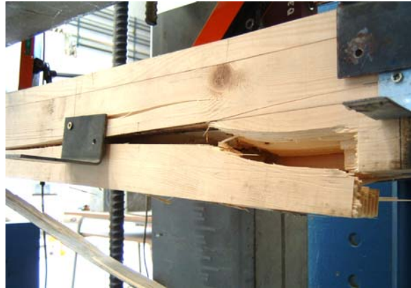
Figura 4. 53 – Rotura da viga V12, por uma ligação tipo finger joint entre lamelas.
