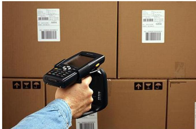
Figura 2.19 - Exemplo leitor RFID [7].
