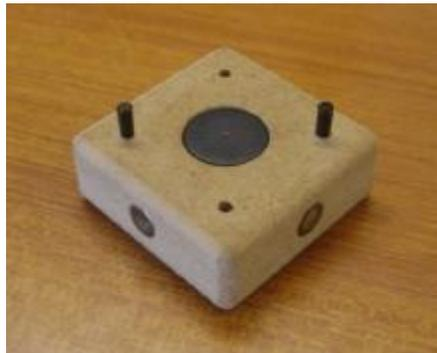
Figura 3.9 - Peça da linha de fabrico flexível com *Tag-it HF-I Plus* embutida [5].
