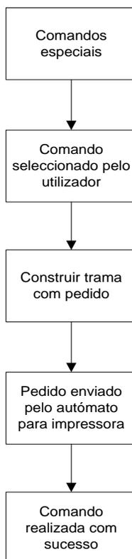
Figura 4.22 - Fluxograma da função imprimir comandos especiais.
