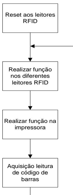
Figura 4.1 - Fluxograma que descreve o princípio de funcionamento da aplicação.
