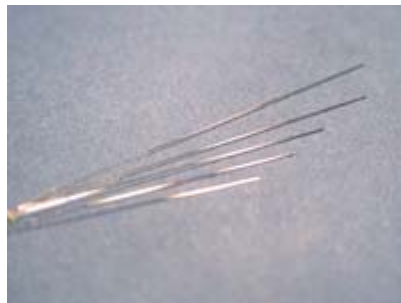
Figura 2.7 – Fibra óptica com revestimento metálico[17]
