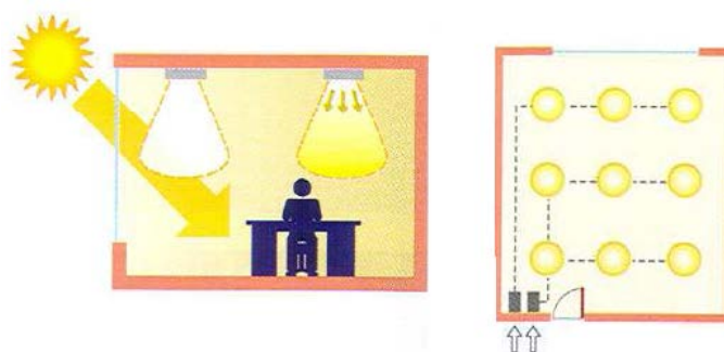
Figura 7.21 - Modo correto da disposição das luminárias [28]
