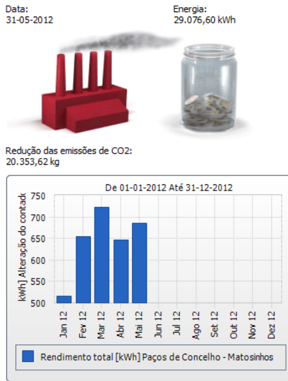
Figura 7.3 - Resumo da produção dos painéis fotovoltaicos instalados no edifício dos Paços do Concelho de Matosinhos [43]
