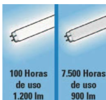
Figura 5.6 - Exemplo de depreciação do fluxo luminoso numa lâmpada fluorescente [29]
