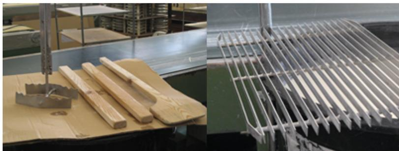
Figura D17 - Ferramentas de vidração (ganchos, paus, colheres, grelhas, etc.)
