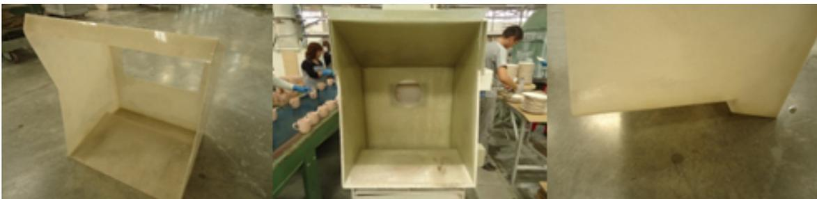
Figura 67 - Protótipo numa fase aproximada da final, composto por fibra de vidro
