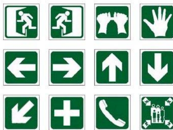
Fig.3.3 – Sinalética de apoio à evacuação de pessoas em caso de incêndio [13]
