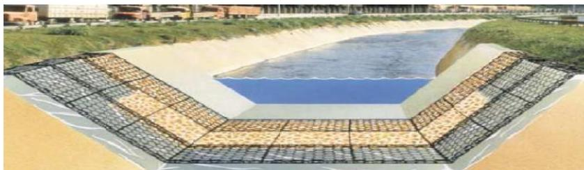
Figura E.11 – Canal fluvial revestido com colchão reno (M. Lemos 2008).
