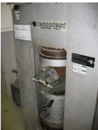
Figura 5 - Ensaio de compressão diametral
