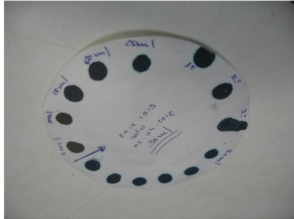
Figura 4 - Pormenor do ensaio de azul de metileno
