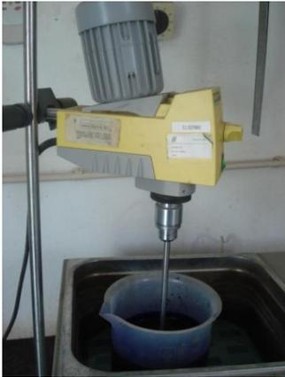
Figura 3 - Ensaio de azul de metileno
