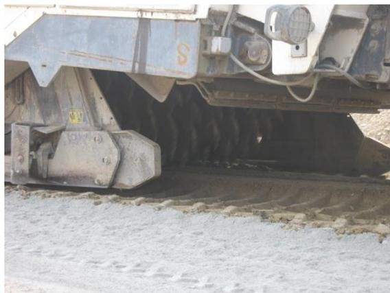
Figura 59 - Pormenor do rotor da recicladora
