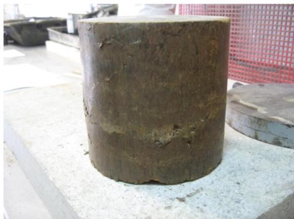
Figura 8 - Provete após ensaio de compressão simples
