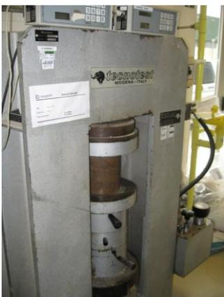
Figura 7 - Ensaio de compressão simples
