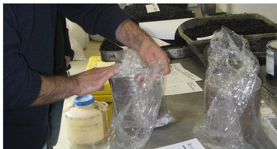
Figura 2 - Forma de armazenamento dos provetes
