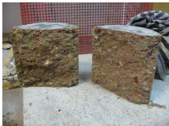
Figura 6 - Provete após ensaio de compressão diametral
