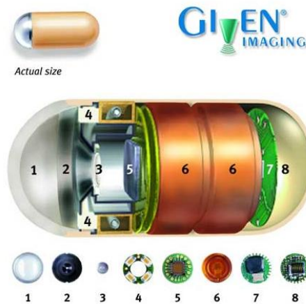
Figura 2.18 – Interior da cápsula endoscópica PillCam SB: 1- Cúpula Óptica; 2 - Suporte da Lente; 3 - Lente; 4 - LEDs de iluminação; 5 - Sensor de imagem CMOS; 6 - Baterias; 7 - Transmissor ASIC; 8- Antena (de [Lima 2008]).
