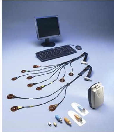
Figura 2.19 – Sistema de aquisição desenvolvido pela empresa Given Imaging: cápsula endoscópica PillCam, sistema de sensores com almofadas de sensoriamento, gravador de dados/pack de bateria e estação de trabalho (de [Lima 2008]).
