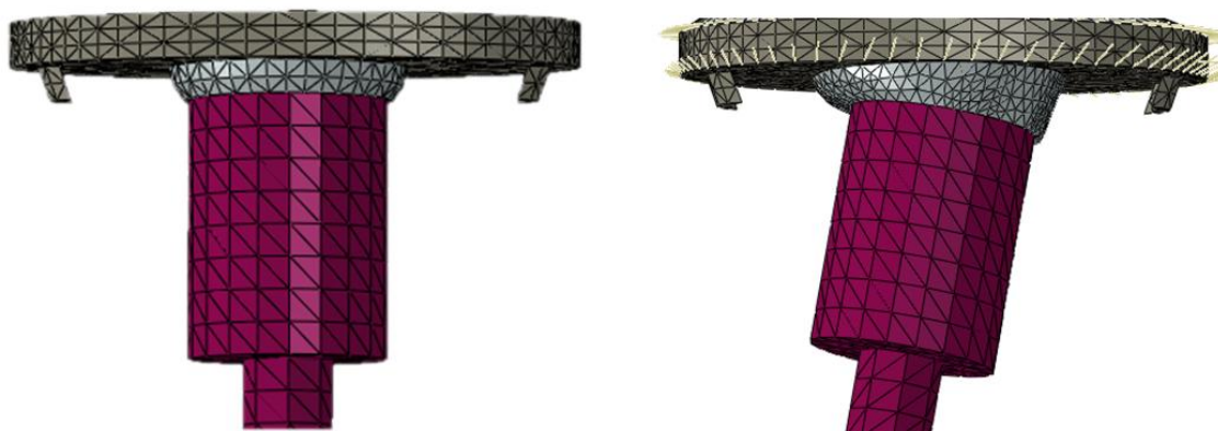
Figura 28 - Modelo geométrico da cola presente na interface TORP - Platina
