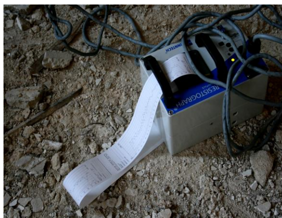
Figura 57 – Resistógrafo, aparelho de leitura [38]
