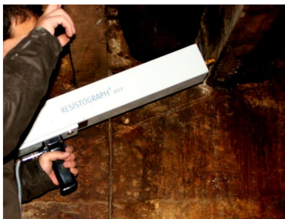
Figura 56 – Resistógrafo, aparelho de penetração no elemento [38]
