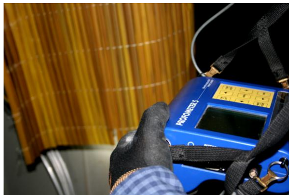
Figura 55 – Pacómetro, ecrã de resultados [38]
