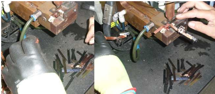
Figura 16 - Operação de soldadura bimetetal-pista de arco
