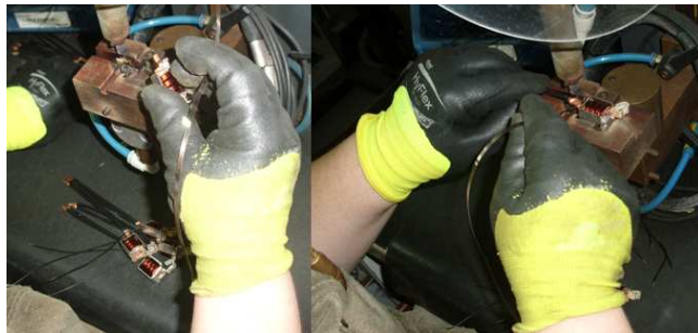
Figura 20 - Operação de soldadura bobine-trança
