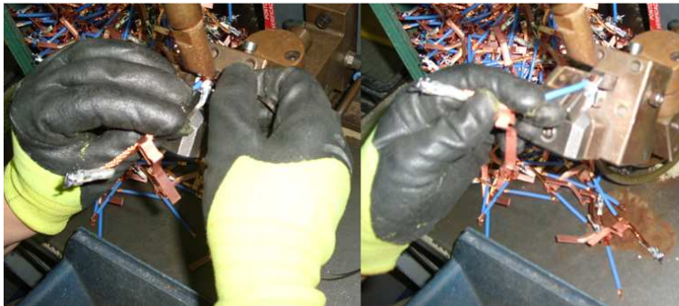
Figura 23 – Operação de soldadura borne curto à trança
