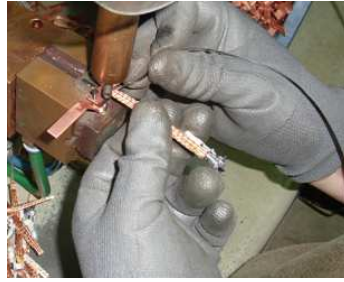
Figura 14- Operação de soldadura pista de arco-trança
