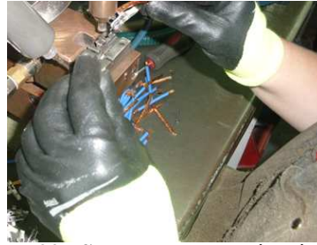
Figura 22 - Soldar contato móvel à trança
