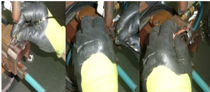
Figura 15 – Operação de soldadura shunt -trança
