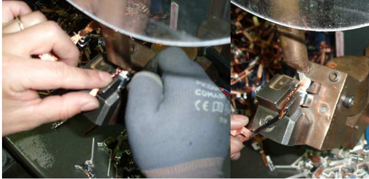
Figura 18- Operação de soldadura borne-trança
