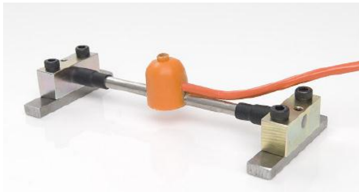
Figura 4.13 - Extensómetros de Corda Vibrante - TSR/5.5/T [28]
