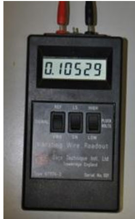
Figura 4.9 - Unidade de Leitura dos Extensómetros
