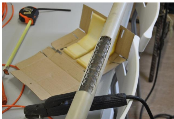
Figura 4.6 - Definição dos comprimentos de selagem e livre
