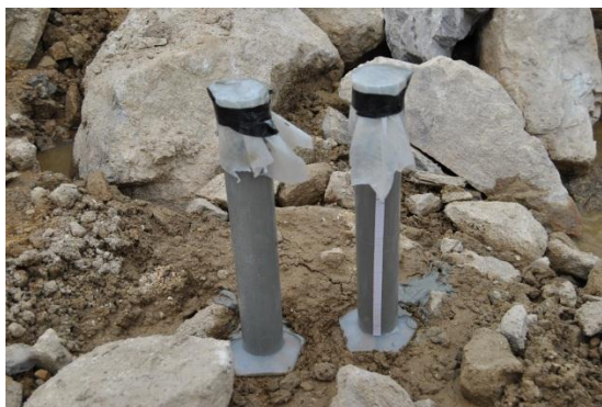
Figura 4.25 - Ensaio de Exsudação - Pregagem 2
