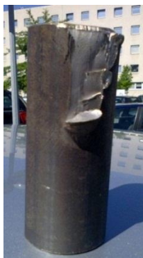
Figura 5.16 - Estado do Acoplador após o Ensaio
