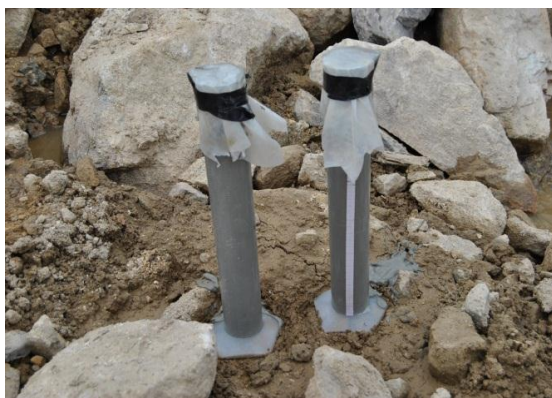
Figura 3.67 - Provetes de Exsudação
