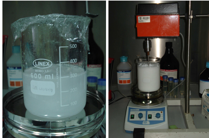
Figura 7 - a) Dissolução do PVA b) Incorporação da hidroxiapatite
