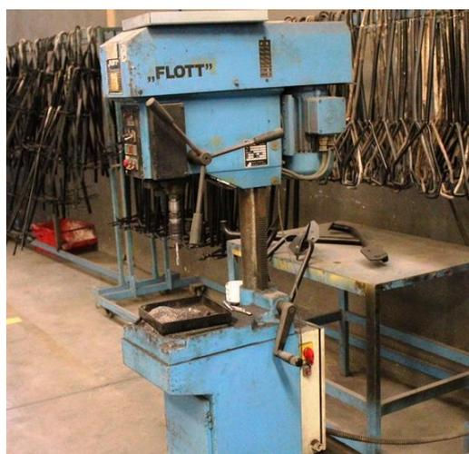
**Figura 15** - Fotografia da máquina de repassar a rosca.
