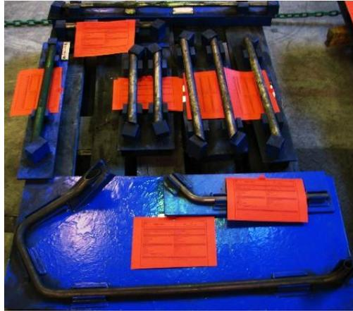
**Figura 17** - Fotografia de *Jigs* de controlo na zona de espera com as respectivas *red tags*.
