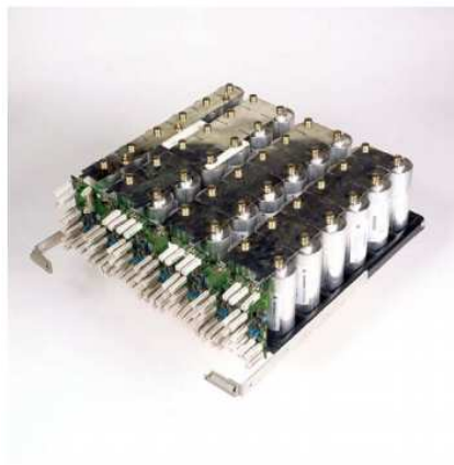
Figura 2.7 - O módulo de supercondensadores utilizado no Sitras SES. [13]
