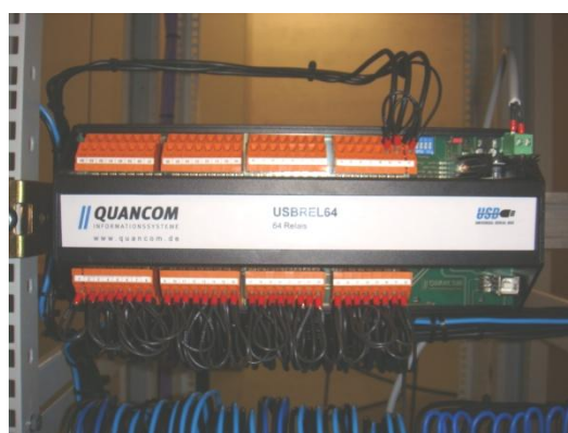
Figura 87 - Placa de Relés comandada pelo “Sound Server”
