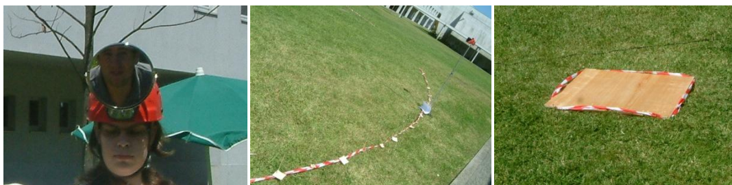
Figura 70 - Mais à esquerda uma foto do sistema do capacete com o espelho acoplado; No centro uma foto da gradação realizada com pequenas estacas de madeira legendadas e separadas com um espaçamento de 2° em torno de cada altifalante; À direita um grande plano da pequena plataforma onde os sujeitos de teste se encontraram parados apenas a rodar na direcção dos radiadores sonoros
