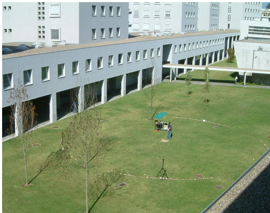
Figura 68 - Foto da zona de testes onde se percebe a circunferência graduada (para a medida). No centro encontra-se a plataforma de madeira onde o sujeito de teste se encontra parado apenas a rodar para a direcção de onde o som provém
