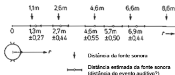
Figura 52 - Erro de localização da distância à fonte sonora com cabeça imobilizada, com uma intensidade de 70 fon a 4m (Blauert, 1983)
