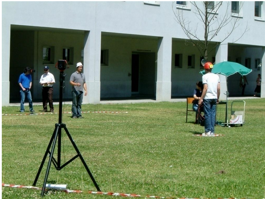
Figura 69 - Foto ilustrativa do processo de medição do desvio angular e do capacete com espelho que o sujeito em teste usou
