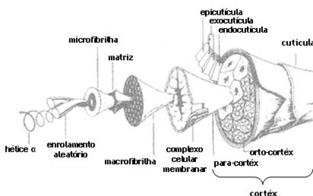
Figura 2.1: Representação esquemática dos componentes morfológicos da fibra de lã (Marti et al. , 2004).
