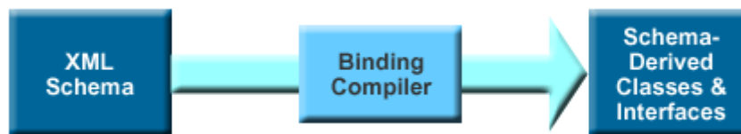
Figura 7: Conversão automática de esquema de XML para classes Java
