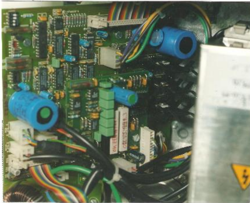
Figura 22. Vista (à esquerda) e Diagrama de componentes (à direita) da Placa de Controle do Estimulador Magnético MagLite-r25.
