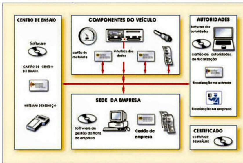
Figura 12 – Esquema de funcionamento do tacógrafo digital
