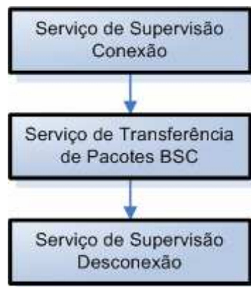
Figura 16: Serviços para comunicação ethernet
