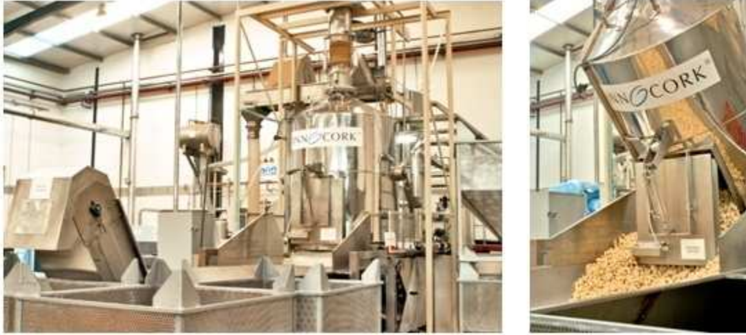
Figura 17. INNOCORK ®– Processo de desodorização e remoção de odores estranhos.
