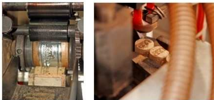
Figura 18. Marcação a Tinta (esquerda) e Marcação por Indução térmica (direita).
