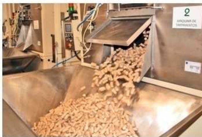
Figura 19. Imagem do tambor de aplicação de Tratamento de Superfície.
