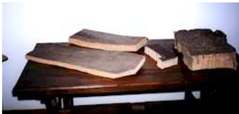
Figura 13. Imagem de cortiça cozida com diferentes qualidades e calibres.
