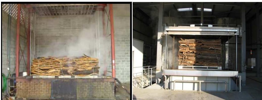
Figura 12. Caldeiras de cozedura de cortiça. Caldeiras artesanais (aberta e com usando madeira) (Figura da esquerda) Caldeiras mais recentes (fechada, e usando gás natural) (Figura da direita)
