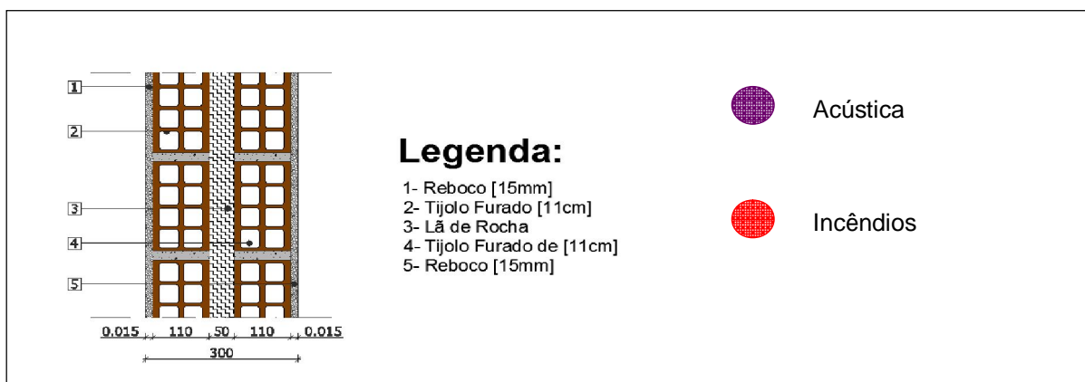
Fig.2.4: Pormenor de parede entre fogos. Exigências principais.
