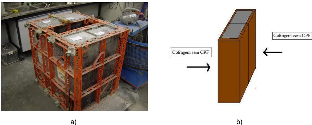
Figura 22 – a) Parede betonada b) esquema de parede betonada
