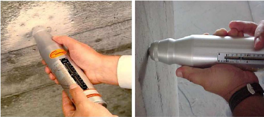
Figura 29 – Esclerómetro de Schmidt
