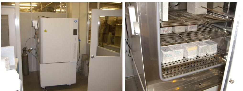
Figura 33 – a) Câmara de carbonatação b) Provetes na câmara de carbonatação
