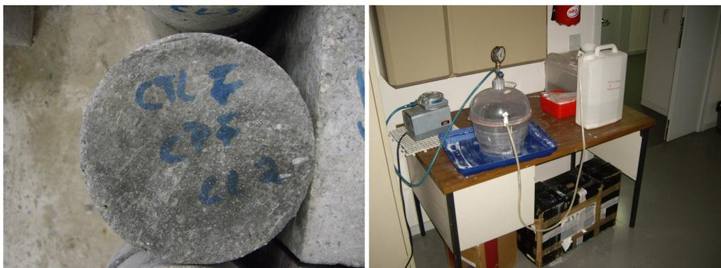
Figura 35 – a) Provette de ensaio aos cloretos b) Equipamento de saturação por vácuo
