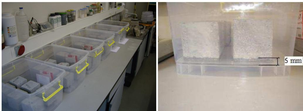
Figura 40 – a) Caixas consideradas para o ensaio de penetração de água sob pressão
