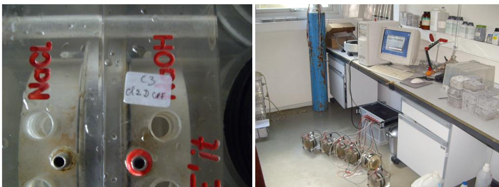
Figura 36 – a) Células acrílicas do ensaio aos cloretos b) Equipamento de registo de resultados
