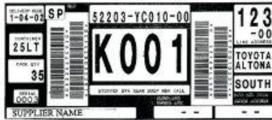
Figura 10 - Kanban do tipo cartão usado pela Toyota
