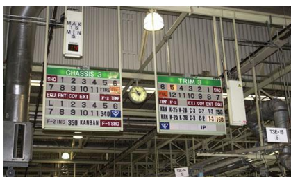
Figura 8 - Exemplo de Quadro Andon de uma fábrica da Toyota
