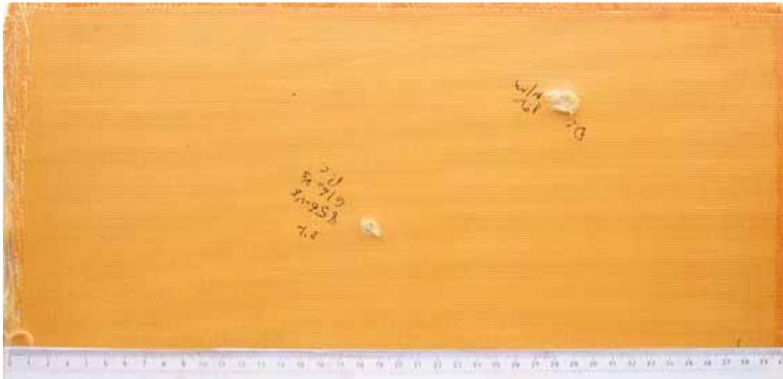
Figura 5.111 Face de impacto da placa 18C\_P1 ensaiada.
