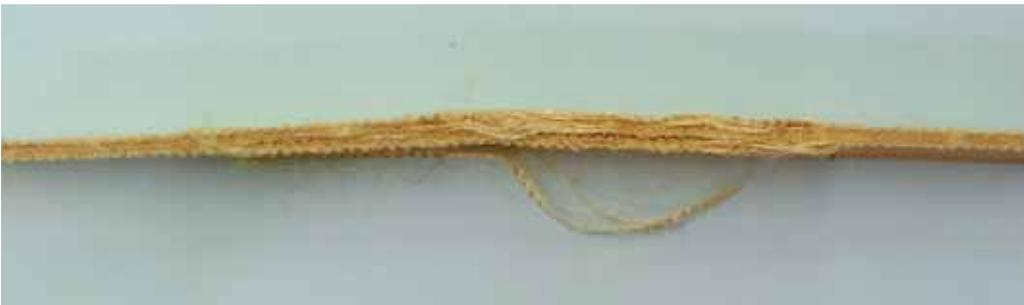
Figura 3.4 Delaminagens na zona central de provete rectangular em Kevlar<sup>®</sup> 129.
