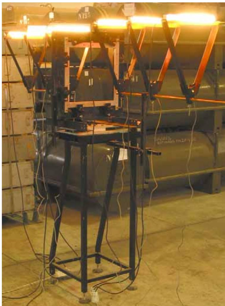
Figura 4.19 Sistema de amarração dos provetes e banca de ensaios utilizados.
