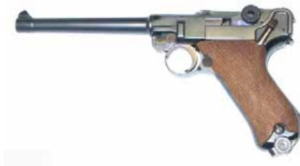
Figura 4.6 Pistola Parabellum, de calibre 7.65 Parabellum, utilizada para velocidades de impacto entre 300 e 600  $m/s$ .
