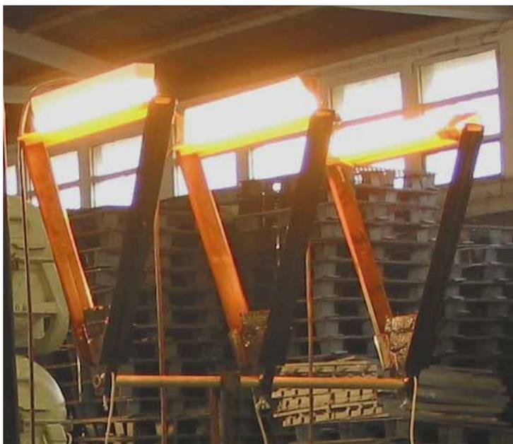
Figura 4.17 Ecrãs de detecção de projecteis do sistema Oehler Model 35P Proof Chronograph.
