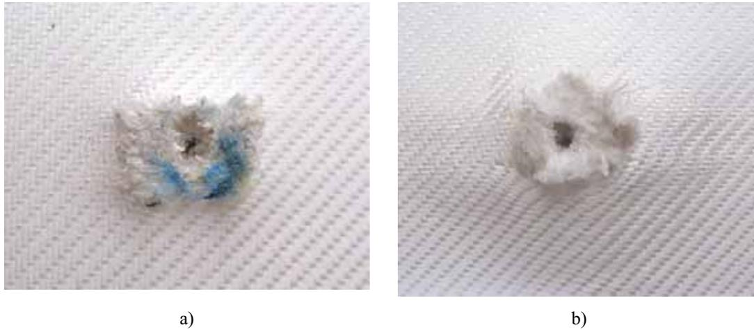
Figura 5.11 Face de impacto na placa BD7\_1, com velocidade de impacto de 1258 *m/s* e velocidade residual de 956 *m/s*.
