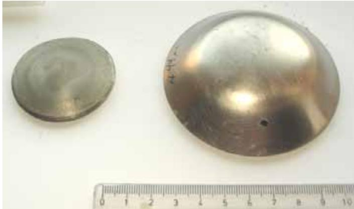
Figura 3.94 Vista posterior do conjunto placa testemunha, provete e *backing plate* recolhidos após teste do provete de Dyneema® SK66 a 396 *m/s*.
