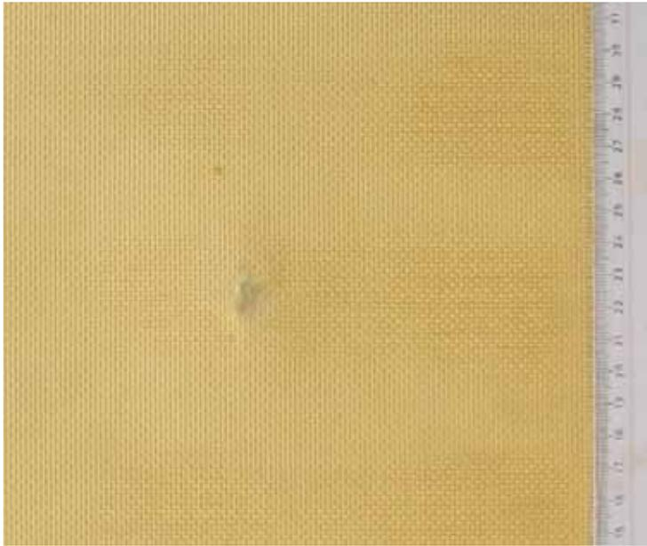
Figura 5.42 Face posterior ao impacto da placa 18C\_P2 ensaiada.
