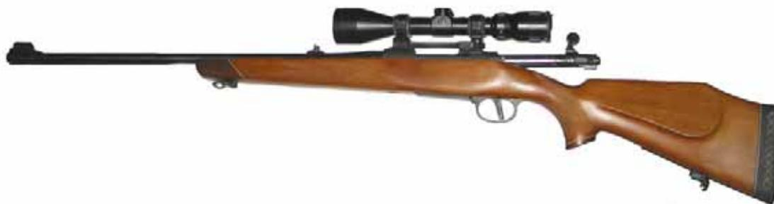
Figura 4.9 Espingarda CZ de calibre 0.308 Winchester utilizada para velocidades de impacto entre 600 e 850  $m/s$ .
