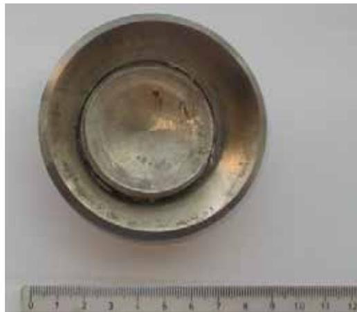
Figura 3.95 Vista do lado do impacto do conjunto placa testemunha, provete e *backing plate*, recolhidos após teste do provete de Dyneema® SK66 a 396 *m/s*.
