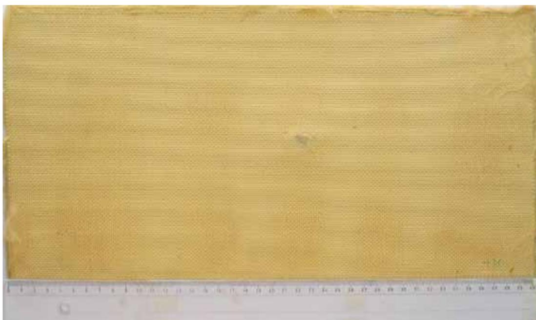
Figura 5.119 Face posterior ao impacto da placa 18C\_P2 ensaiada.
