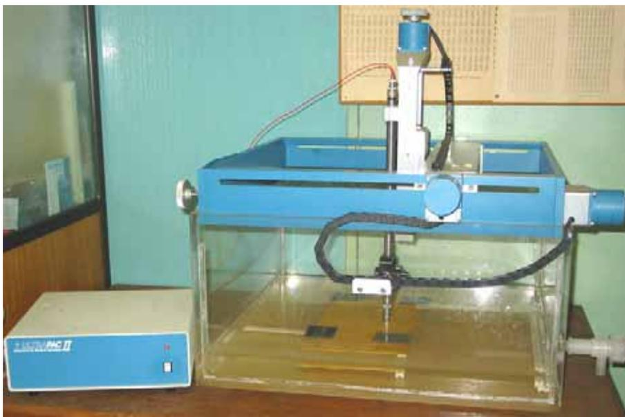
Figura 5.28 Equipamento de ultra-sons utilizado.
