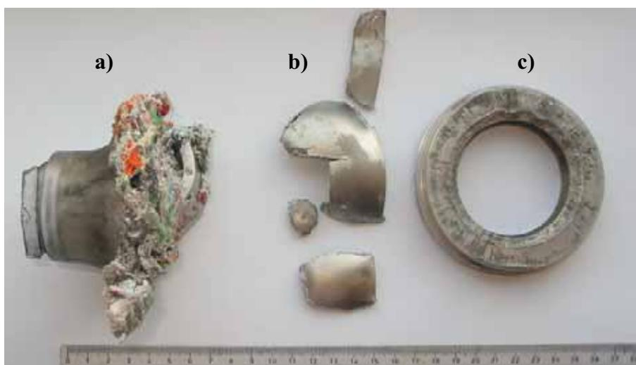
Figura 3.93 Fragmentos recolhidos após teste do provete de Kevlar<sup>®</sup> 129 a 1028  $m/s$ : a) sabot, b) placa testemunha e c) anel de suporte da placa testemunha.
