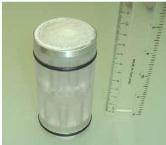
Figura 3.75 Conjunto *sabot*, *flyer plate* e amostra de material em Dyneema<sup>®</sup> SK66.
