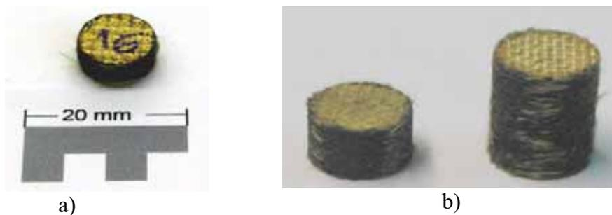
Figura 3.21 Provetes de Kevlar<sup>®</sup> 129 fabricados para ensaios de compressão em regime *quasi*-estático e dinâmico. a)  $\phi=10\text{ mm}$  b)  $\phi=18\text{ mm}$ .
