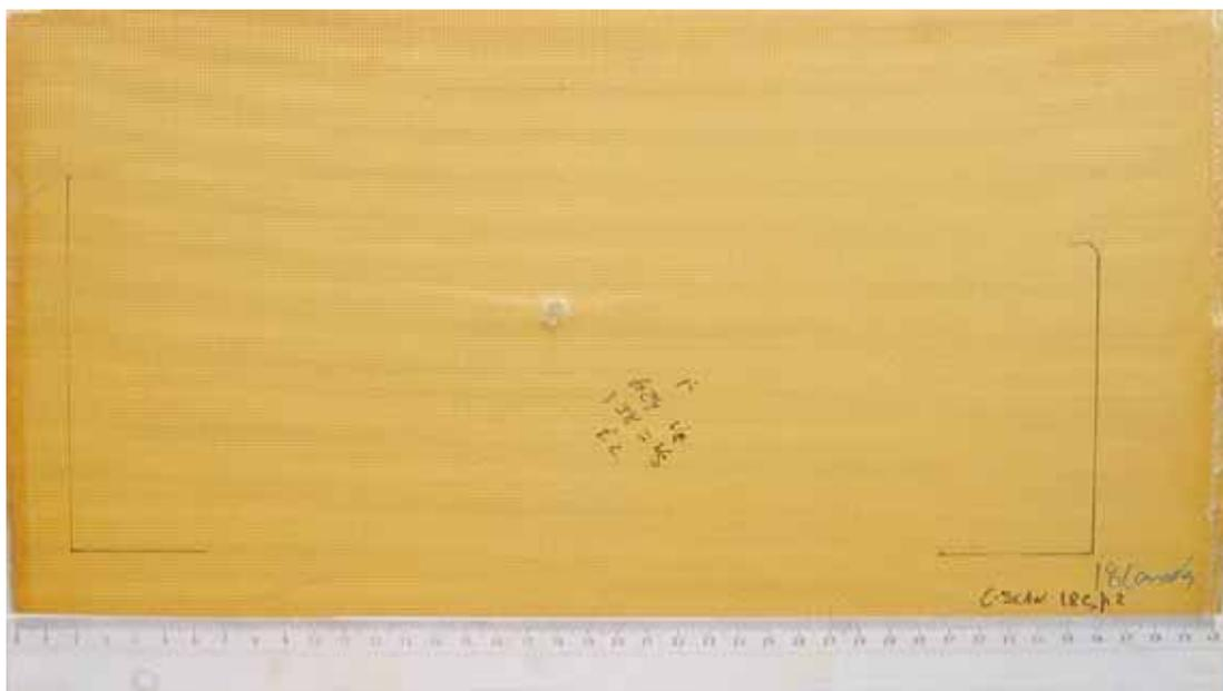
Figura 5.118 Face de impacto da placa 18C\_P2 ensaiada.
