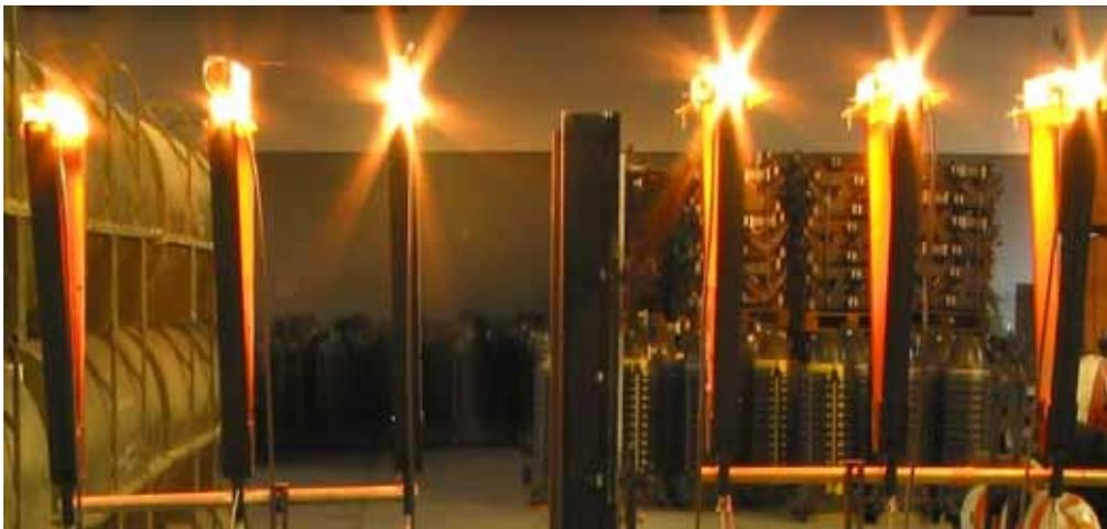
Figura 4.18 Montagem utilizada para medir a velocidade de impacto e a velocidade de saída do projectil.
