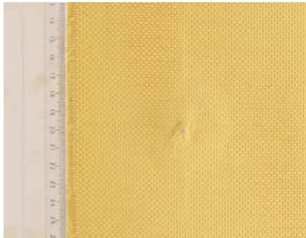
Figura 5.31 Face posterior ao impacto da placa 5C\_P2 ensaiada.
