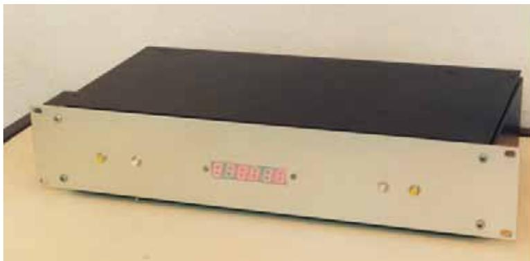
Figura 4.16 Sistema de contagem do tempo construído.
