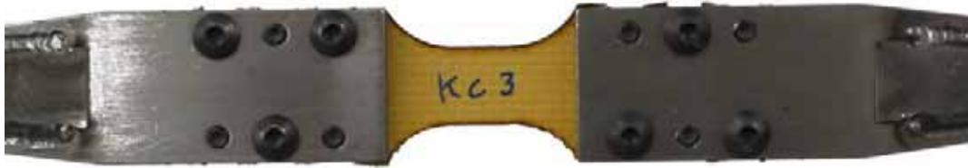
Figura 3.52 Versão final das amarras de fixação do provete para ensaio de tracção.
