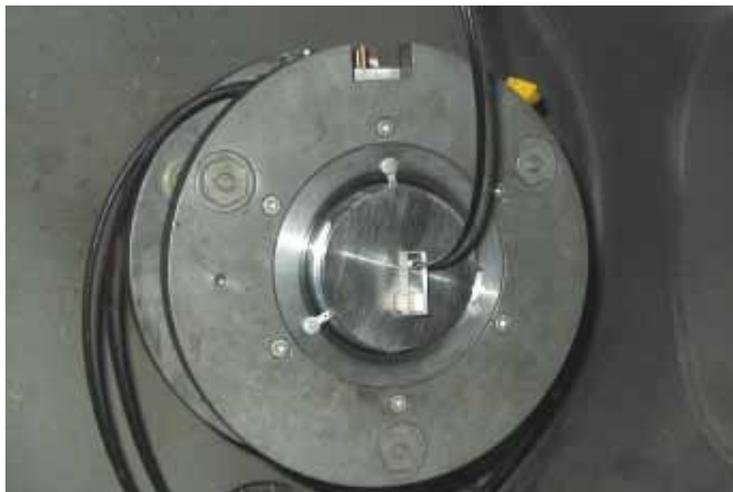
Figura 3.82 Aplicação do sistema *VISAR* à superfície posterior da placa testemunha para um dos ensaios.
