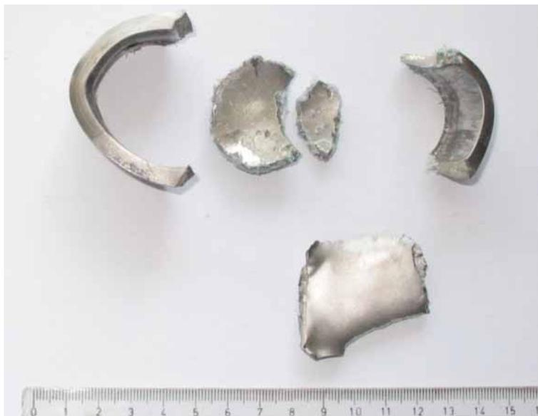
Figura 3.96 Fragmentos recolhidos após ensaio do provete de Dyneema® SK66 a 1028 *m/s*.
