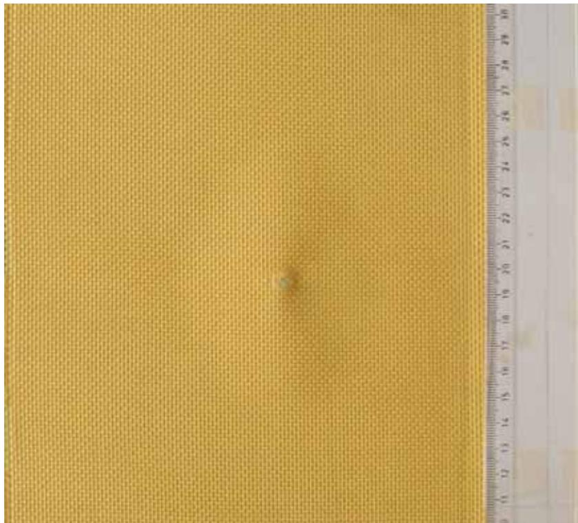
Figura 5.38 Face posterior ao impacto da placa 11C\_P1 ensaiada.
