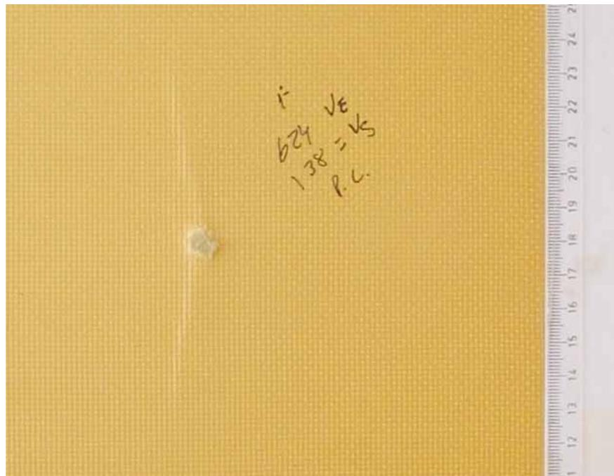
Figura 5.40 Face de impacto da placa 18C\_P2 ensaiada.
