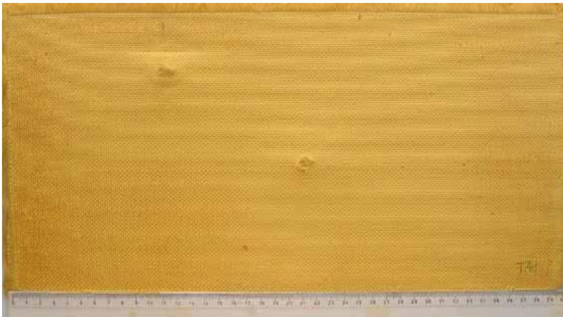
Figura 5.112 Face posterior ao impacto da placa 18C\_P1 ensaiada.
