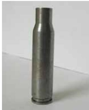
Figura 4.4 Redutor de calibre utilizado para aumentar a densidade de carregamento.
