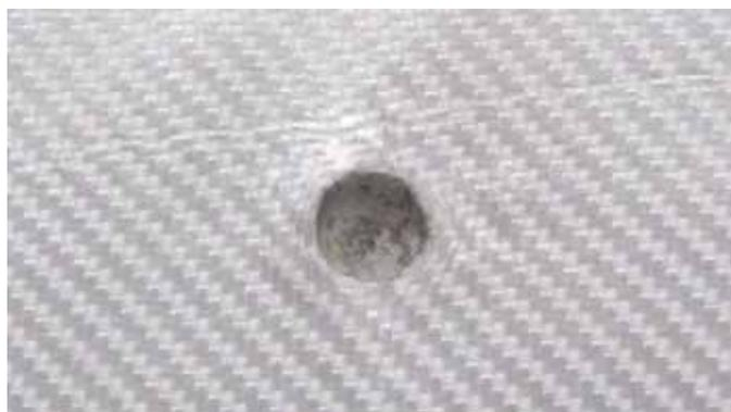
Figura 5.9 Impacto na placa BD2\_1, com penetração parcial.
