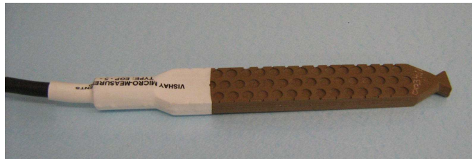
Figura 5.7 Extensómetro de resistência eléctrica de embeber no betão
