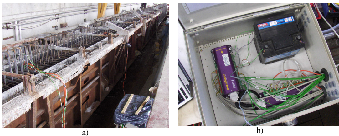
Figura 6.12 a) ‘Set-up’ de instrumentação da viga; b) sistema de aquisição de dados
