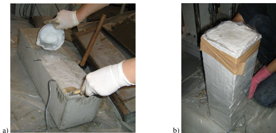
Figura 4.4 Impermeabilização do prisma de retracção autógena: a) aplicação da parafina líquida; b) envolvimento com película aderente
