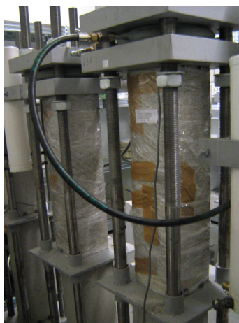
Figura 4.2 Dispositivo para ensaio de fluência
