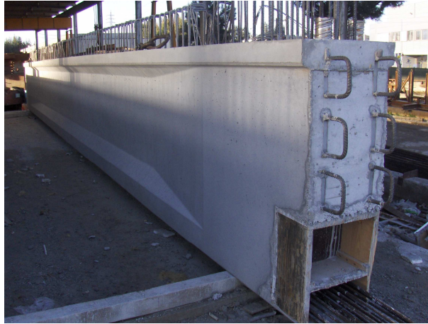
Figura 6.2 Viga pré-fabricada de secção I com largura variável
