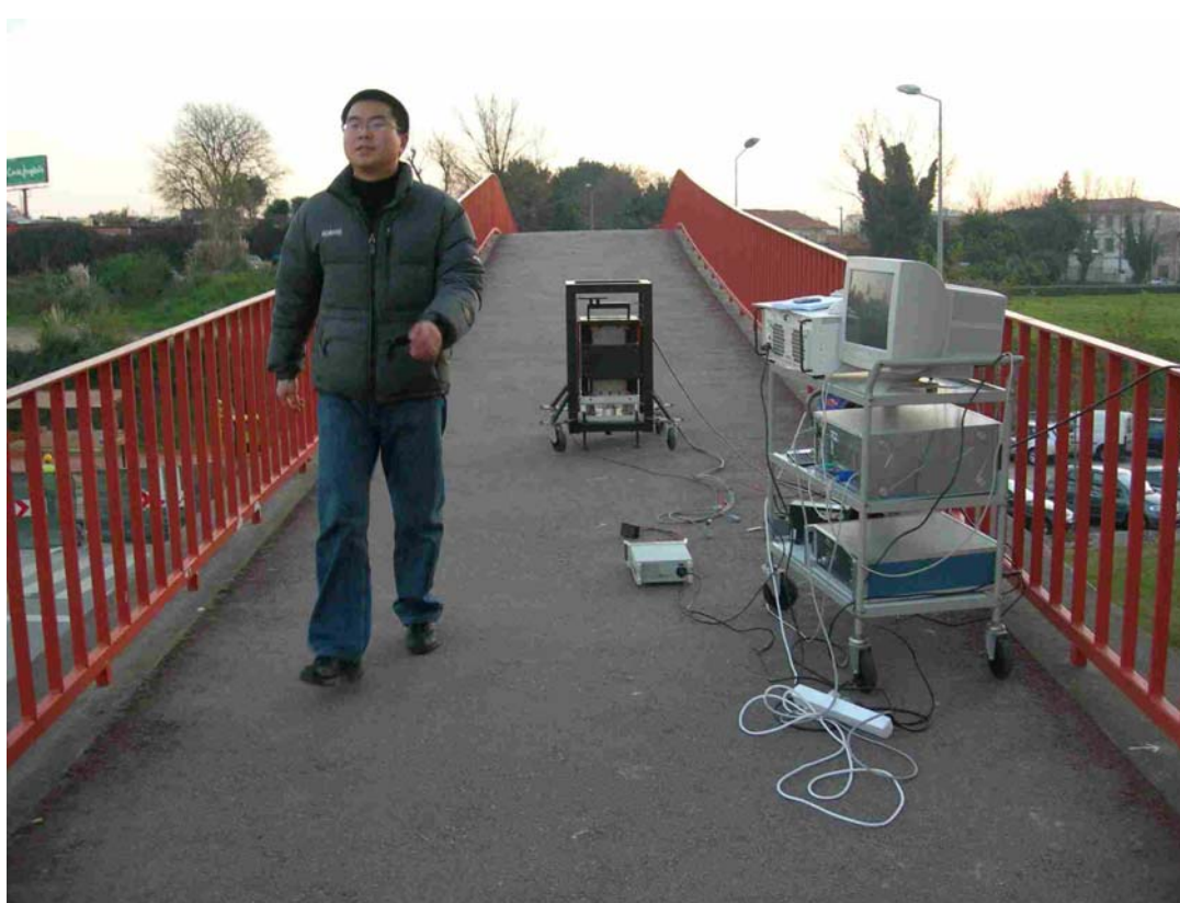
Figura 6.16 – Peão em andamento percorrendo a ponte
