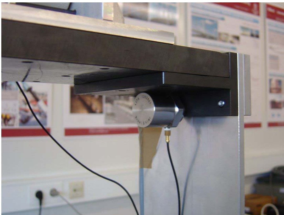
Figura 5.25 – Acelerómetro posicionado ao nível do último piso
