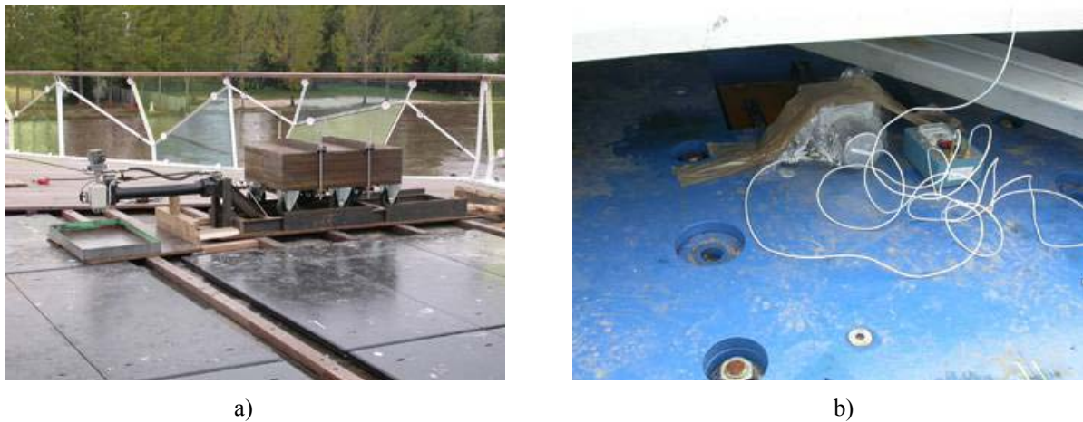
Figura 6.28 – a) Dispositivo mecânico para ensaio de vibração forçada; b) Instrumentação de TMD durante varrimento sinusoidal
