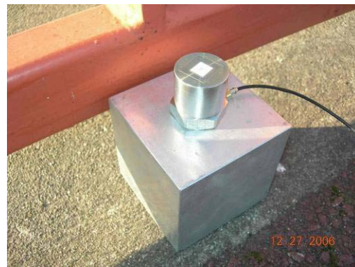
Figura 6.13 – a) Células de carga responsáveis por medir as forças de interacção; b) Acelerómetro utilizado na medição da resposta da estrutura
