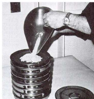
Fig.3.1 – Colocação do agregado na série de peneiros (ACI, 1978)
