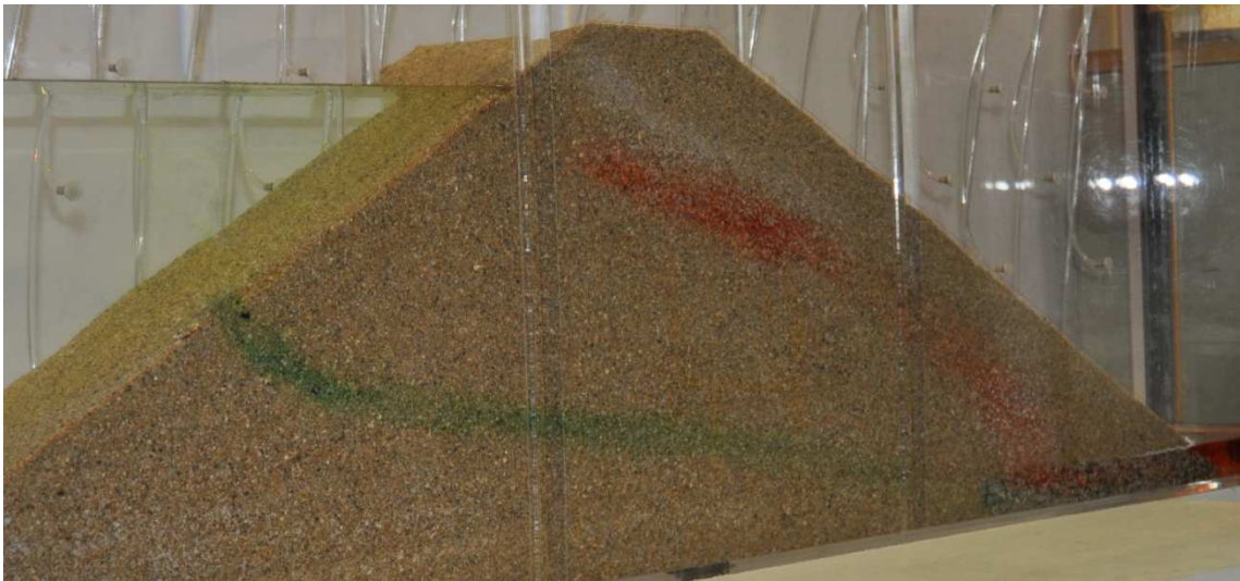
Fig.6.1 – Trajectória do produto corante no meio poroso
