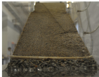
Fig.6.18 – Fenómeno de ressurgência da água no paramento de jusante
