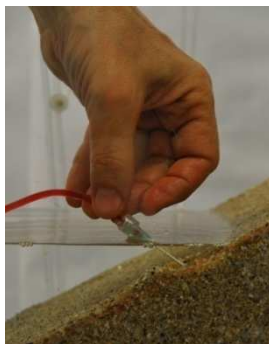
Fig.4.6 – Processo de injeção do produto corante
