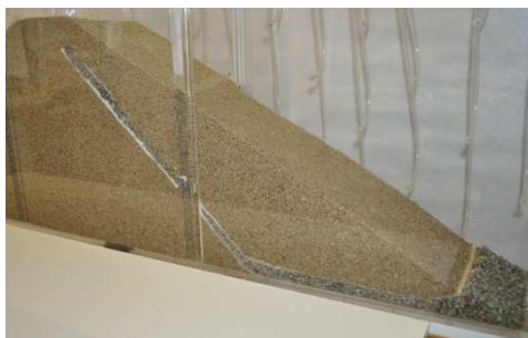
Fig.4.16 – Detalhe do dreno de chaminé
