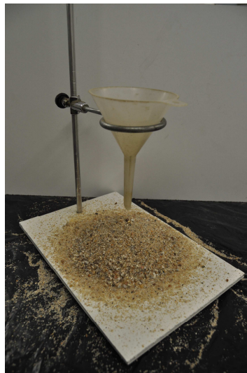
Fig.3.6 – Montagem laboratorial para a estimativa do ângulo de atrito efectivo
