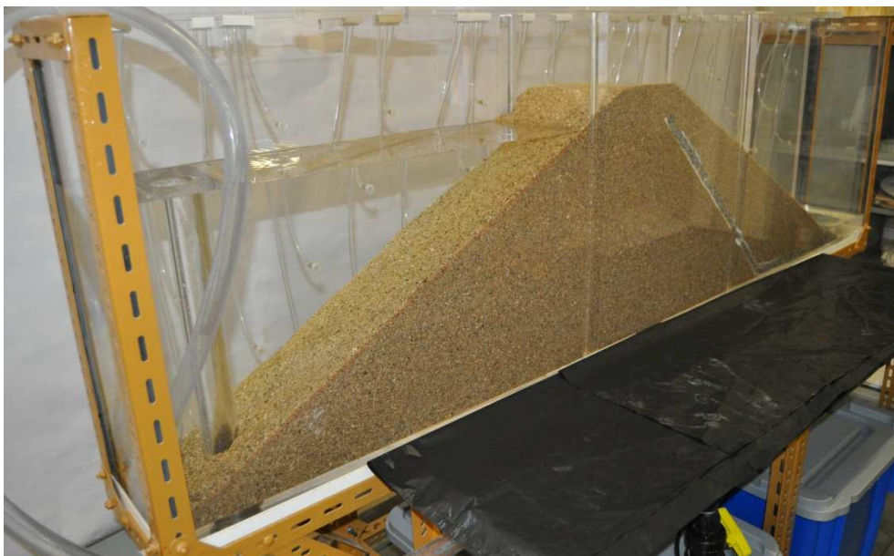
Fig.4.15 – Modelo físico da barragem homogênea com dreno de chaminé
