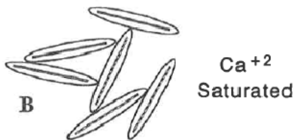
Figura 3.4 - Adição de cal provoca a diminuição da camada de água e permite a flocculação (Dallas Little, 1995)
