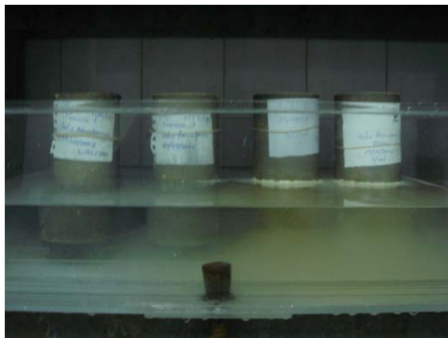
Figura 4.58 – Cura de provetes de solo natural e estabilizado com 3% de cal imersos em água até 1/3 da sua altura – S300
