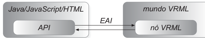
Esquema 3.7 Comunicação através de uma EAI.
