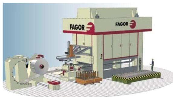
Figura 15 - Esquema de uma prensa mecânica com sistema de alimentação e transfer automático
