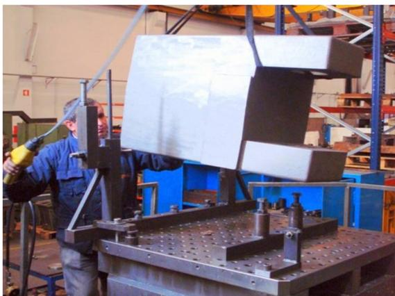
Figura 22 – Posicionamento da peça na ferramenta
