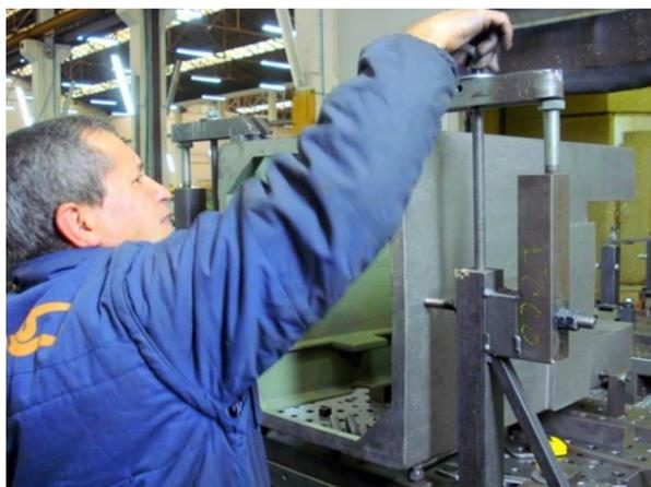
Figura 23 – Aperto da peça na ferramenta
