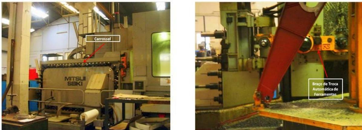
Figura 16 – Carrossel e braço automático de troca de ferramentas do centro Mitsui H6C
