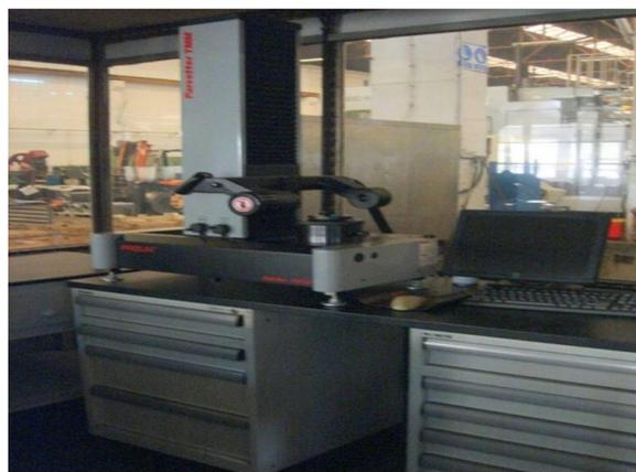
Figura 40 – Presetter de ferramentas de corte
