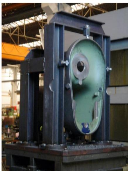
Figura 63 – Ferramenta de posicionamento de uma das peças da nova amassadeira
