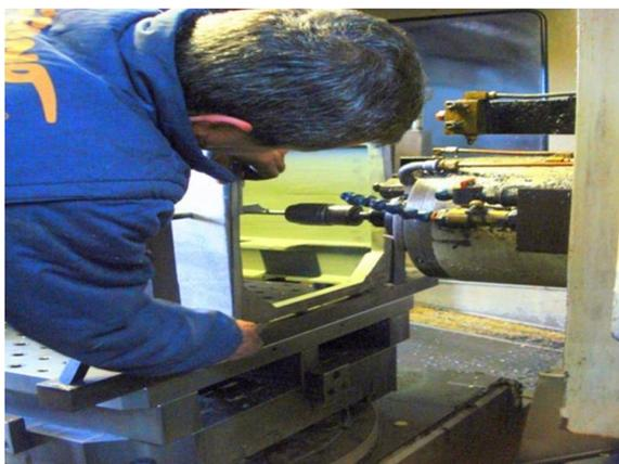
Figura 26 – Execução do zero-peça
