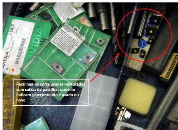
Figura 39 – Exemplo de desarrumação na gaveta de uma bancada
