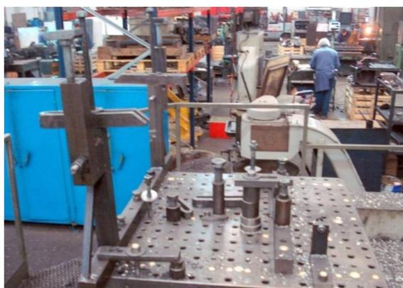
Figura 34 – Exemplo de ferramenta de posicionamento de fixação modular
