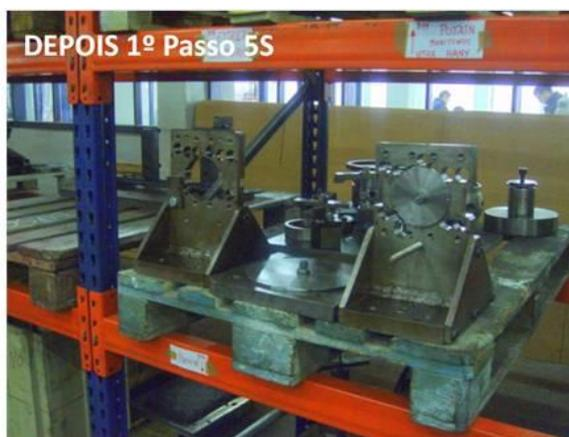
Figura 56 – *Ferramentas de posicionamento após implementação do 1º passo 5S*
