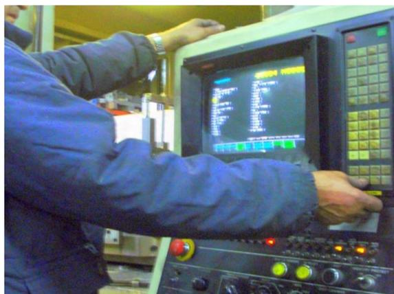
Figura 25 – Introdução dos parâmetros no controlo da máquina
