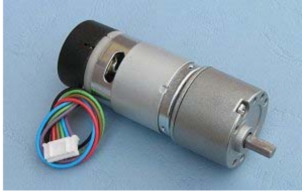
Figura 3.1.10 Motor/caixa redutora e encoder EMG30.
