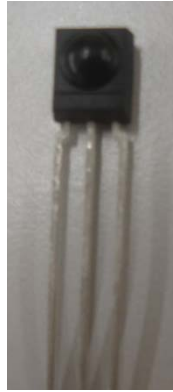
Figura 3.1.7 Receptor de infravermelhos para controlo remoto TSOP34836.
