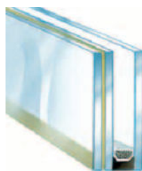
Figura 2.27 – Representação de um vidro laminado num sistema de vidro duplo [39]
