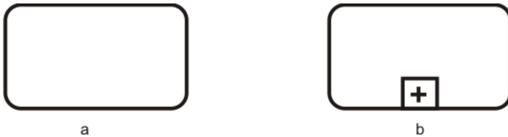
Figura 20: Representação gráfica de uma atividade (a) e exemplo de uma atividade do tipo subprocesso (b).
