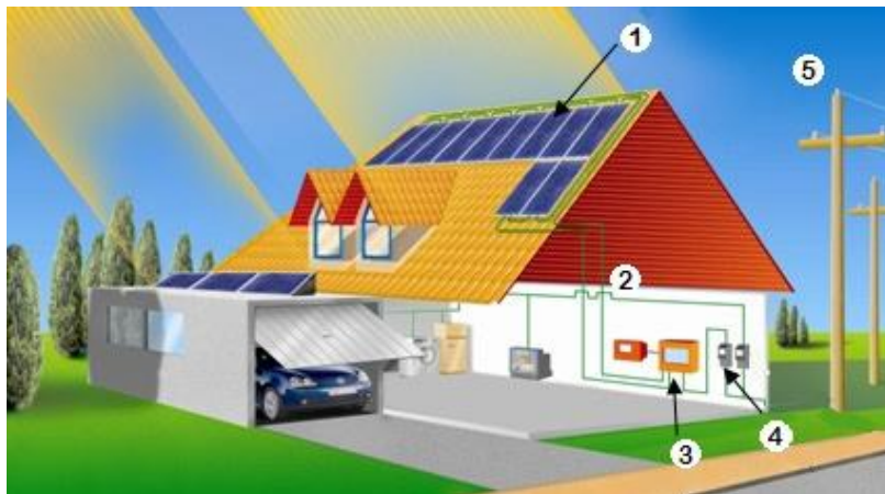
Figura 22. Representação de um sistema fotovoltaico ligado à rede eléctrica, (Planob, 2009).
