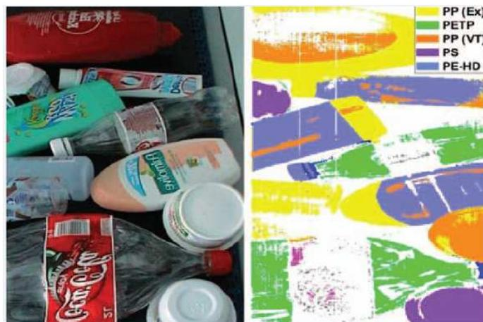
Fig. 2.6 - Imagem de garrafas de plástico obtidas por um sistema multiespectral que permite diferenciar a sua composição química. [10]
