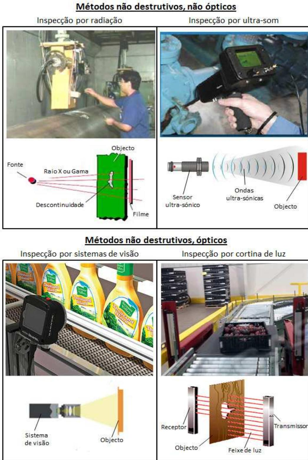
Fig. 1.3 - Exemplos de métodos de inspeção não destrutivos não ópticos (em cima) e ópticos (em baixo).
