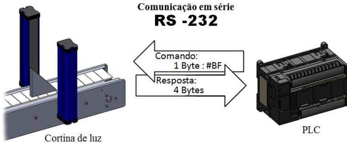
Fig. 3.4 - Representação esquemática do modelo digital com resposta a comando.
