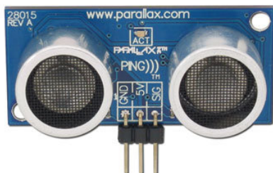
Figura 3.8: Sensor de distância ultra-sónico, Parallax's PING)))
