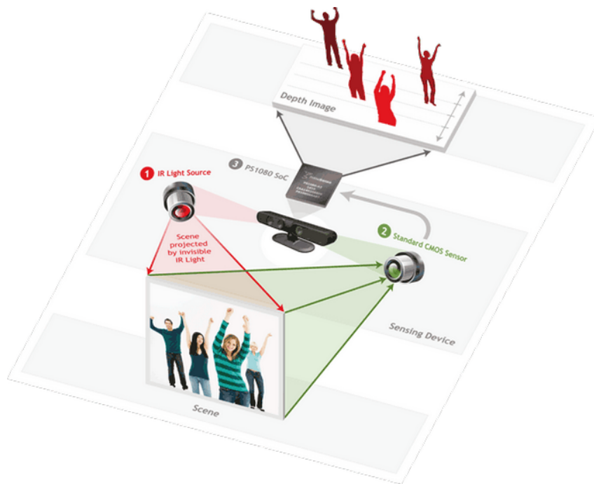
Figura 3.2: Kinect com o hardware assinalado
