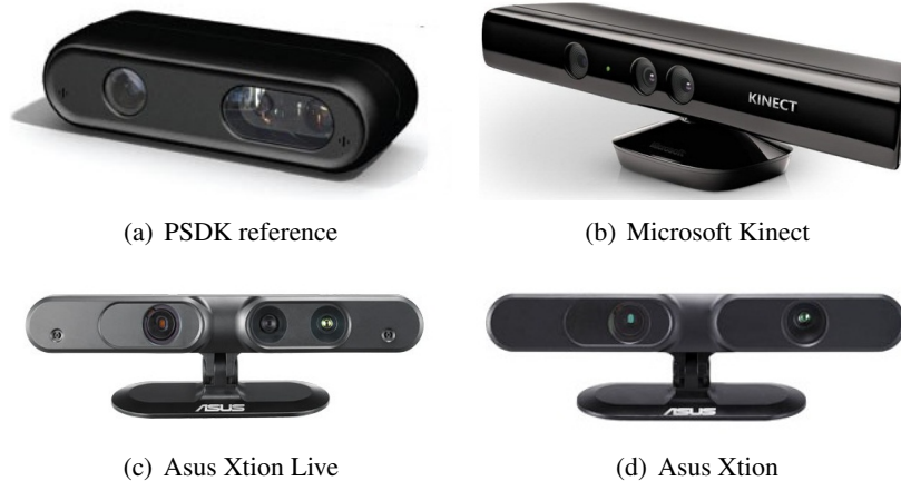
Figura 3.3: Dispositivos de mapeamento 3D desenvolvidos pela PrimeSense
