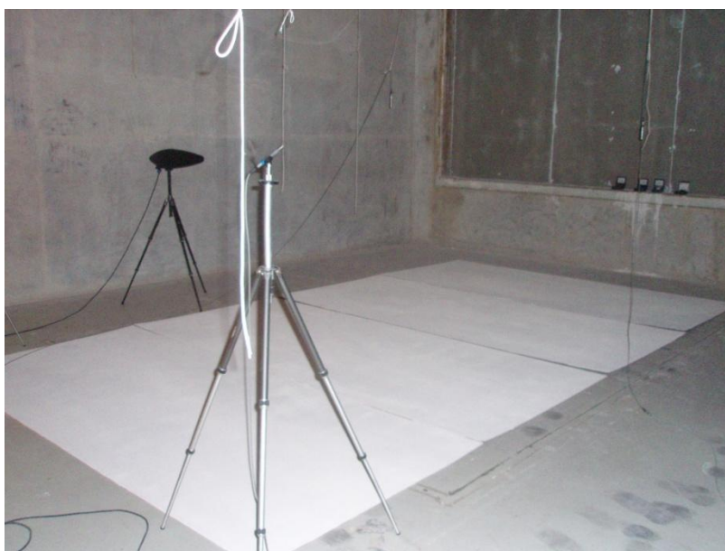
Figura B.8 – Fotografia de uma posição relativa da fonte sonora durante o ensaio da amostra de madeira com aplicação de duas demãos de tinta Vinylsilk com 3% de incorporação de pó de cortiça.
