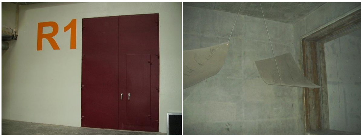
Figuras 6.4 e 6.5 – Entrada e aspecto interior da câmara reverberante R1 da FEUP [46].
