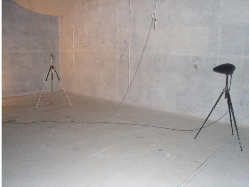
Figura B.5 – Fotografia de uma posição relativa da fonte sonora durante os ensaios com a câmara vazia.
