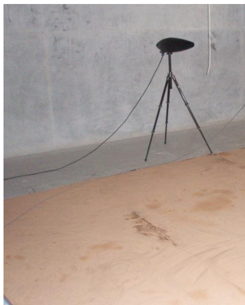
Figura B.10 – Fotografia de uma posição relativa da fonte sonora durante o ensaio da amostra com Pó de Cortiça em emulsão.
