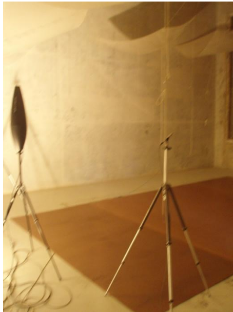
Figura B.6 – Fotografia de uma posição relativa da fonte sonora durante o ensaio da amostra de madeira.
