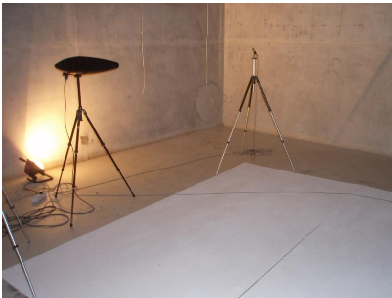
Figura B.7 – Fotografia de uma posição relativa da fonte sonora durante o ensaio da amostra de madeira com aplicação de uma “tinta/massa” Vinylsilk com 5% de pó de cortiça.
