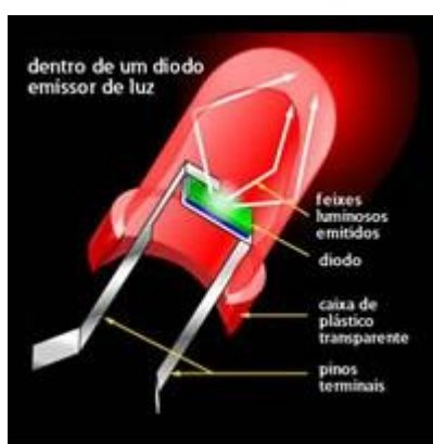
Figura 4.8 - Esquema de funcionamento de um LED [35]
