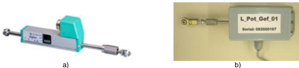
Figura 5.22 – LVDT utilizado: a) aspecto do aparelho adquirido; b) aspecto do aparelho após a preparação realizada no LESE.
