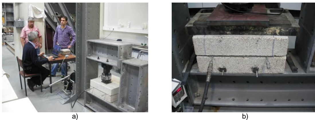
Figura 5.18 – Dispositivo utilizado no teste dos macacos planos em laboratório: a) vista geral; b) pormenor.
