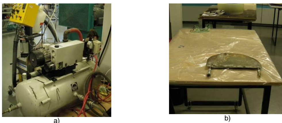
Figura 6.13 – Utilização da bomba de vácuo: a) bomba de vácuo; b) preparação do macaco.
