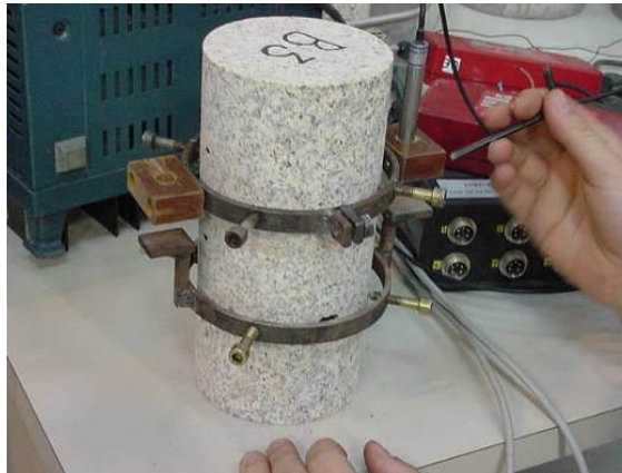
Figura 3.43 – Preparação do ensaio para determinação do módulo de elasticidade (LESE, 2005).
