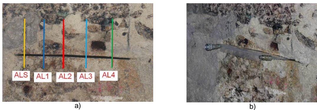
Figura 6.15 – Ensaio simples de macacos planos: a) após realização do rasgo com os 5 alinhamentos realizados; b) macaco plano e folha de PET colocados.
