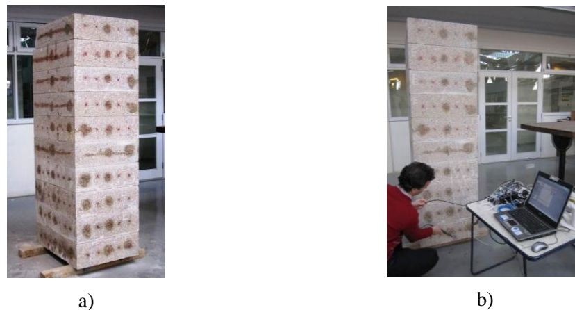
Figura 3.51 – Pedras de granito com superfícies lisas: a) vista das pedras agrupadas; b) execução de um ensaio indirecto ascendente.
